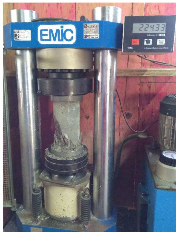
Figura 37 - Ruptura de corpo de prova de concreto
