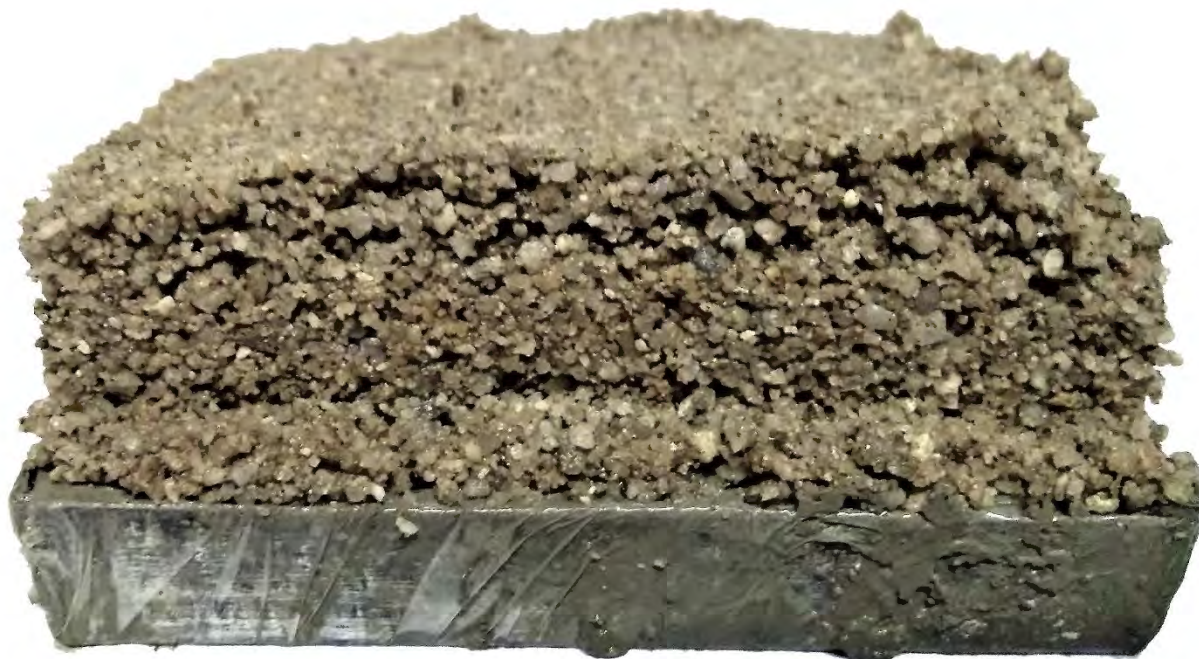
Figura 131 - Tempo de cura 0h - Nível do concreto -2mm
