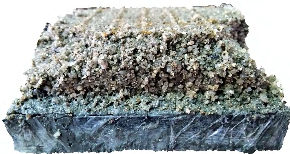
Figura 132 - Tempo de cura 15h - Nível do concreto 0mm
