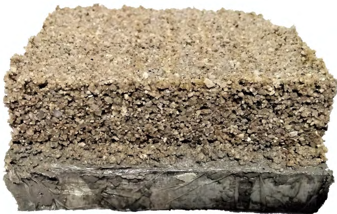
Figura 130 - Tempo de cura 0h - Nível do concreto 0mm
