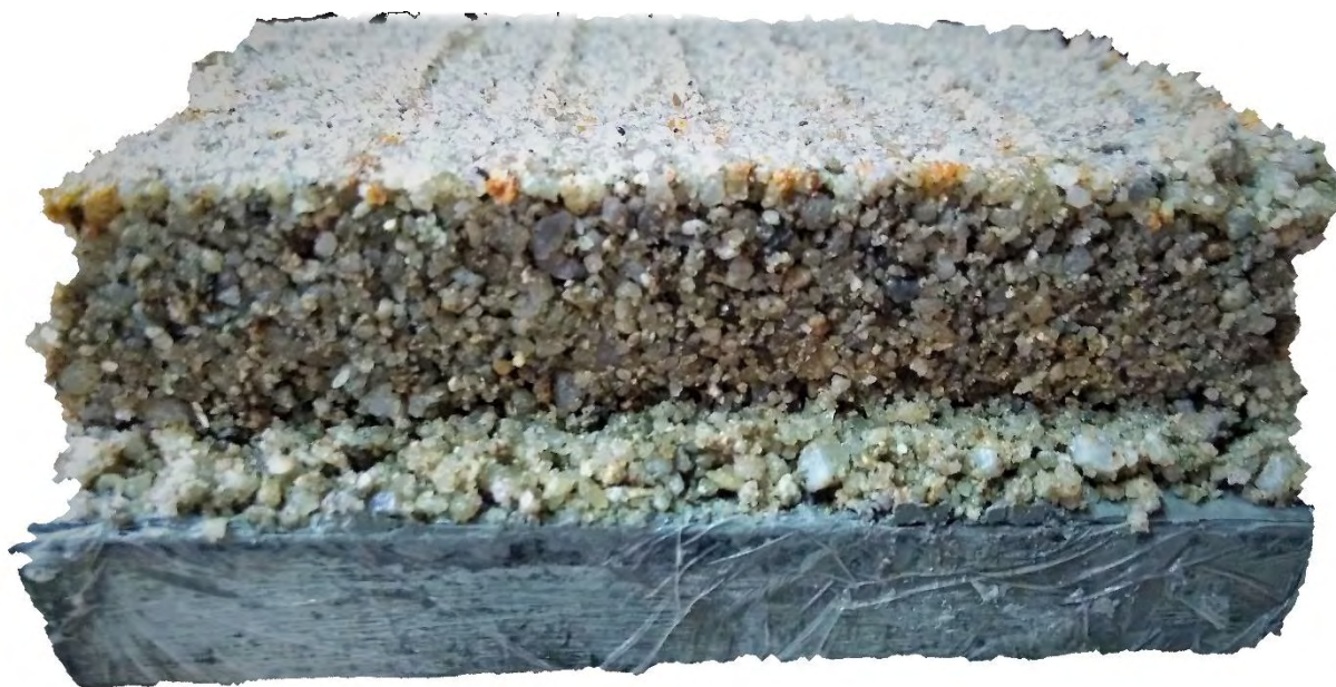
Figura 133 - Tempo de cura 15h - Nível do concreto -2mm
