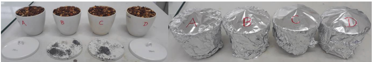
FIGURA 10 - PREPARAÇÃO DAS CASCAS DE LARANJA SECAS PARA A PIRÓLISE
