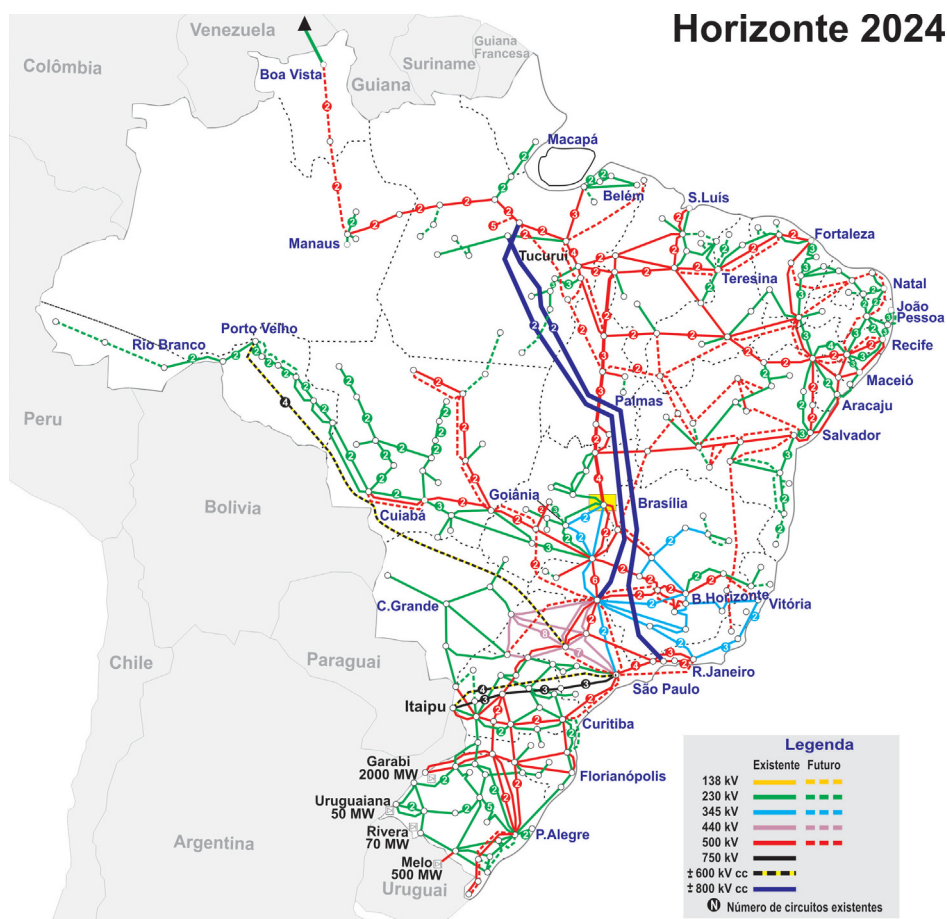
Figura 1: SIN, representando o sistema de transmissão interligado (ONS, Operador Nacional do Sistema Elétrico, 2020b).
