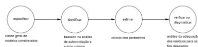
Figura 1: Estágios do ciclo iterativo da construção de um modelo de séries temporais FONTE: Adaptado de Morettin e Toloí (2006)
