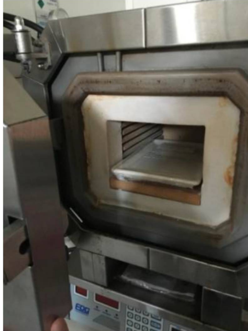
FIGURA 5 - FORNO A VÁCUO EDG 3000 UTILIZADO PARA TRATAMENTO TÉRMICO DOS DTL.
