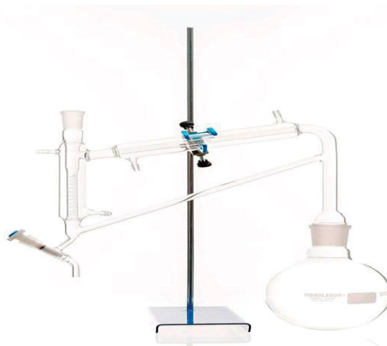
FIGURA 12 - APARELHAGEM PARA DESTILAÇÃO POR ARRASTE USANDO CLEVENGER
