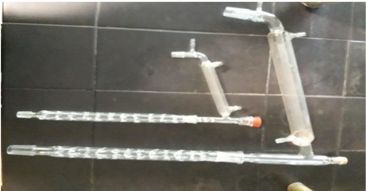
FIGURA 17 – SISTEMA DE DESTILAÇÃO FRACIONADA TRADICIONAL (ABAIXO) E EM ESCALA REDUZIDA (ACIMA)
