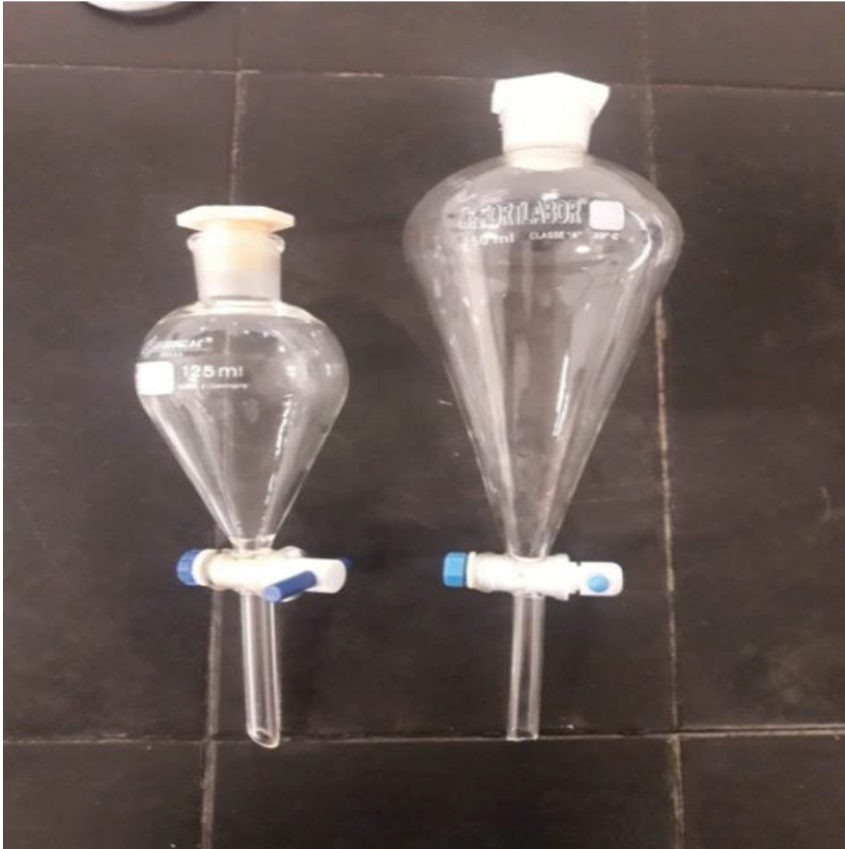
FIGURA 19 – FUNIL DE SEPARAÇÃO TRADICIONAL (À DIREITA) E ADAPTADO, DE MENOR VOLUME (À ESQUERDA)
