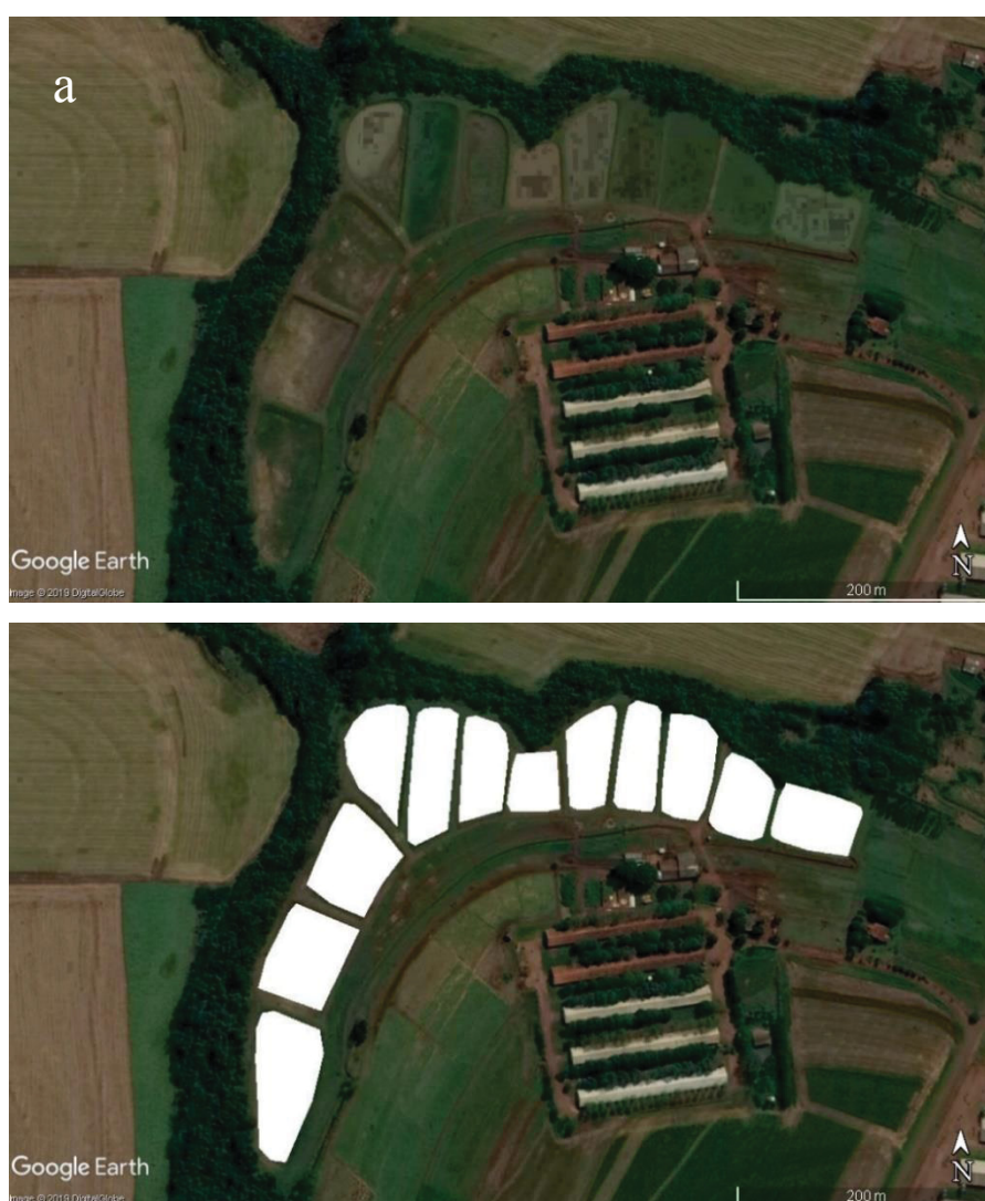
FIGURA A10 – Imagens do Google Earth Pro ® utilizadas para calcular o percentual de ocupação aquícola nas microbacias: a) identificação de tanques de aquicultura na área da microbacia; e b) medição da área de lâmina d'água dos tanques.
