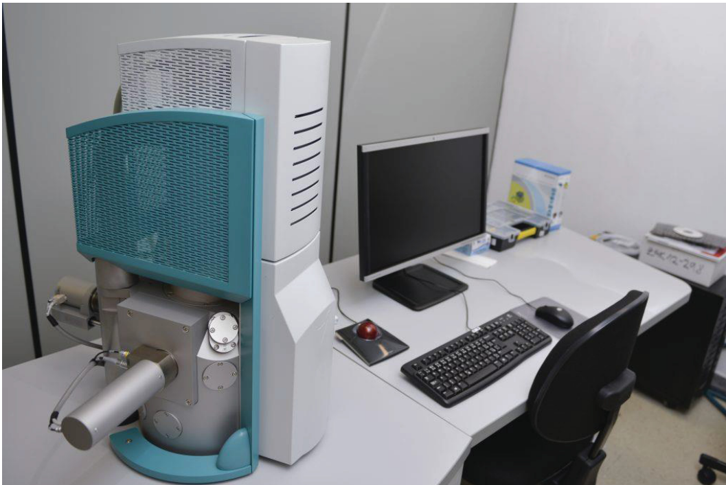
FIGURA 16 – MICROSCÓPIO ELETRÔNICO DE VARREDURA TESCAN VEGA3 LMU
