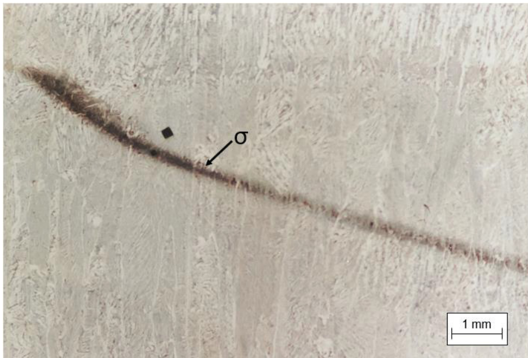
FIGURA 13 – PRECIPITAÇÃO DA FASE SIGMA, APÓS PROCESSO DE SOLDAGEM MULTIPASSE, NO AÇO INOXIDÁVEL AUSTENÍTICO 309L
