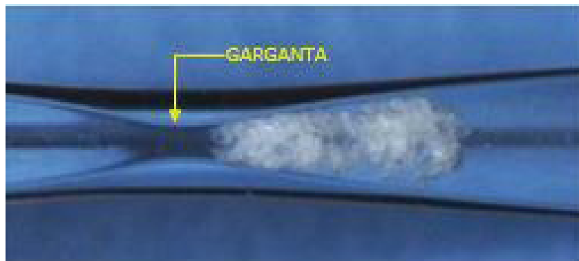
FIGURA 2 – CAVITAÇÃO HIDRODINÂMICA EM UM TUBO DE VENTURI
