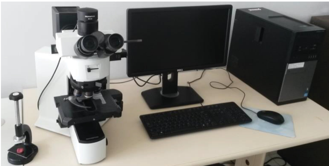
FIGURA 17 – MICROSCÓPIO ÓTICO, MARCA OLYMPUS, MODELO BX-51M
