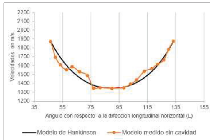
FIGURA 37 - BLOQUE 2, Cedrela odorata , MODELO HANKINSON Y VELOCIDADES MEDIDAS SIN CAVIDAD PARA n = 1,793
