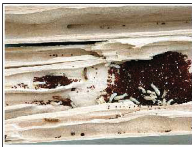
FIGURA 2 - DAÑO DE Cryptotermes brevis EN UNA PIEZA DE MADERA. ESTRUCTURAL DE PINUS SP. ABIERTA, PARA EXPONER A LAS CRÍAS DE C. BREVIS , LAS GALERÍAS Y LOS PELLETS FECALES.
