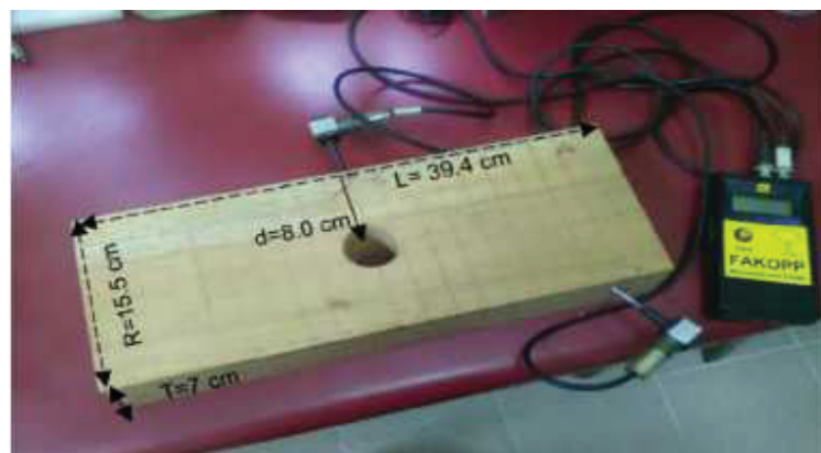
FIGURA 24 - DISPOSICIÓN DE LAS MEDICIONES CON EL EQUIPO DE ULTRASONIDO MICRO TIMER BLOQUE 1
