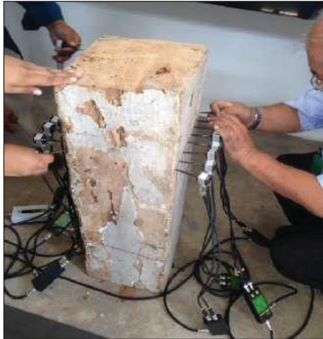
FIGURA 19 - PREPARACIÓN DE LA PRUEBA DE TOMOGRAFÍA ACÚSTICA EN LA VIGA USANDO LA DISPOSICIÓN DE LOS SENSORES EN LÍNEAS PARALELAS PARA MUESTRAS DE SECCIONES RECTANGULARES
