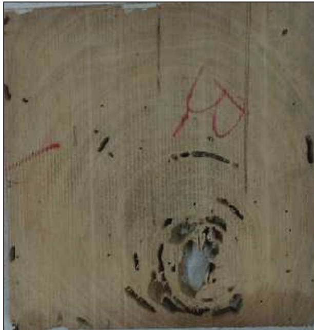
FIGURA 21 - CORTE TRANSVERSAL DE LA MUESTRA EN LA ALTURA DONDE SE EFECTUÓ LA TOMOGRAFÍA, EN LA PARTE INFERIOR SE NOTA LA FORMA DEL ATAQUE DE LAS TERMITAS EN FRANJAS CIRCULARES
