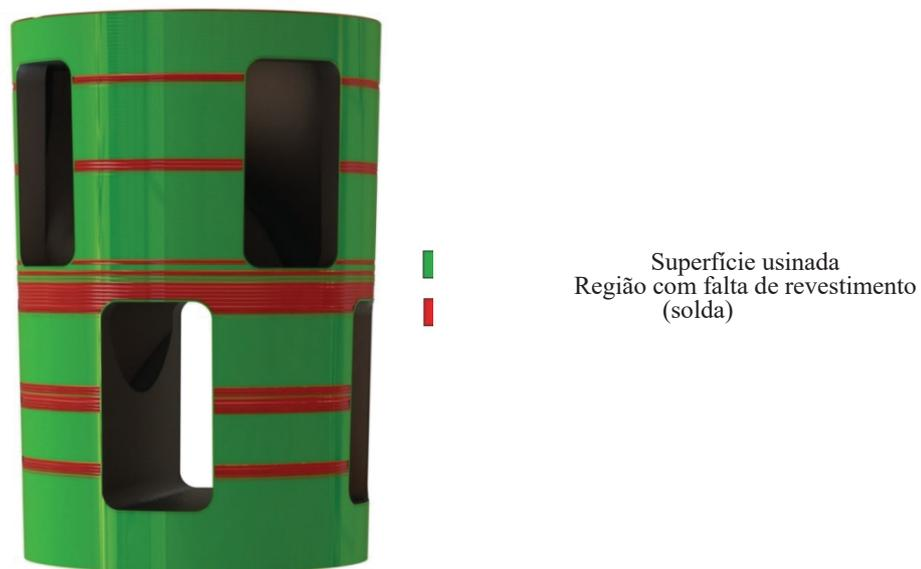
FIGURA 13 - Simulação entre os Modelos do Rotor “Revestido versus Rotor “Usinado”
