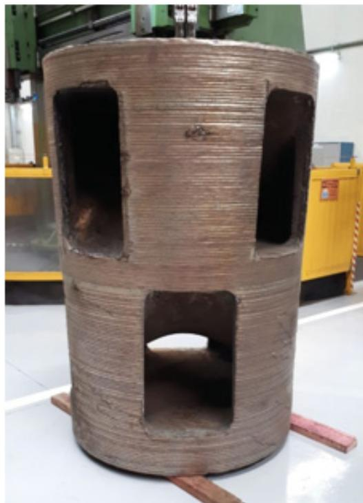
FIGURA 9 - Rotor (Físico) Revestido por Soldagem, através do Processo Arco Submerso
