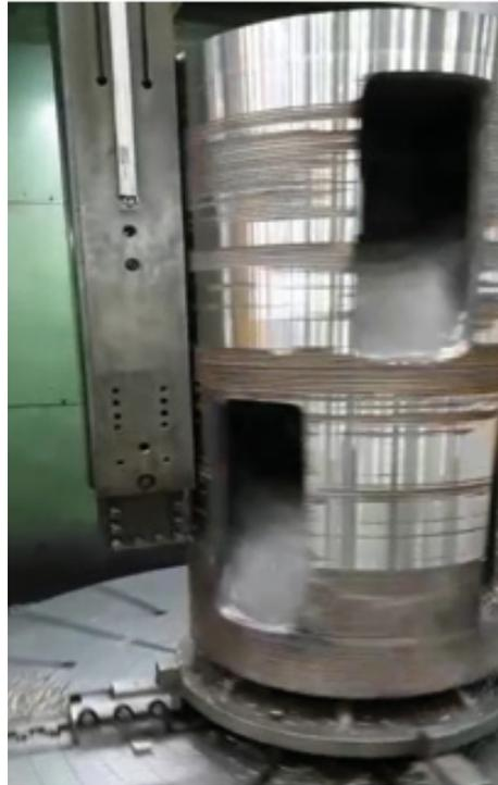
FIGURA 7 - Evidência da Falta de Material em Determinadas Regiões do Rotor
