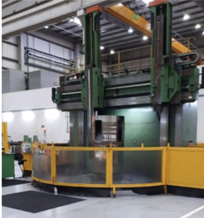
FIGURA 6 - Rotor Durante Processo de Usinagem (Torneamento)
