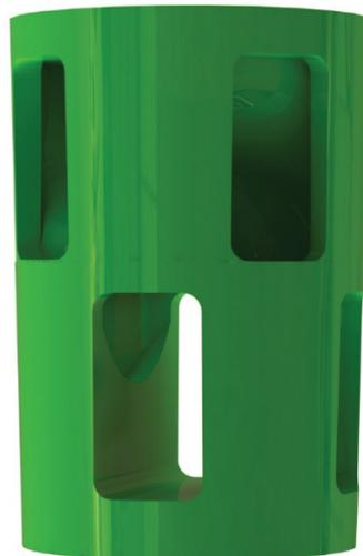
FIGURA 12 - Rotor Usinado Final, ou Modelo Teórico (Modelo Tridimensional) Via SolidWorks
