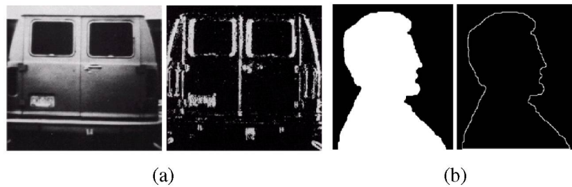
Figura 2.8: Técnicas de segmentação: (a) segmentação por descontinuidade e (b) segmentação por similaridade. Fonte: (Gonzalez e Woods, 2010)
