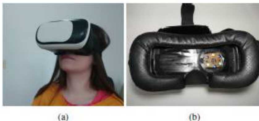
Figura 5.1: Imagens do dispositivo pupilômetro desenvolvido nesta pesquisa.
