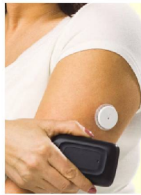
Figura 2.5: Método de leitura glicêmica semi-invasivo. Fonte: (FreeStyle Libre, 2019)
