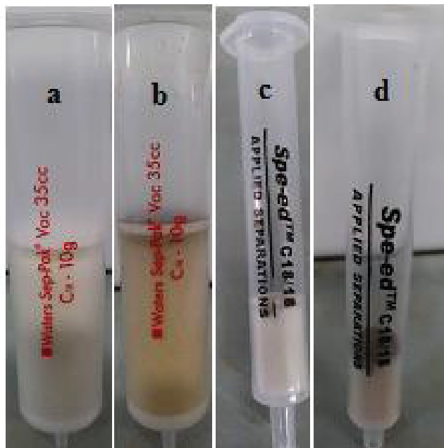
FIGURA III.5 – COLUNAS SEP-PAK VAC 35CC E SPE-ED C18/18 ANTES E DEPOIS DA PASSAGEM DE AMOSTRAS FERMENTADAS
