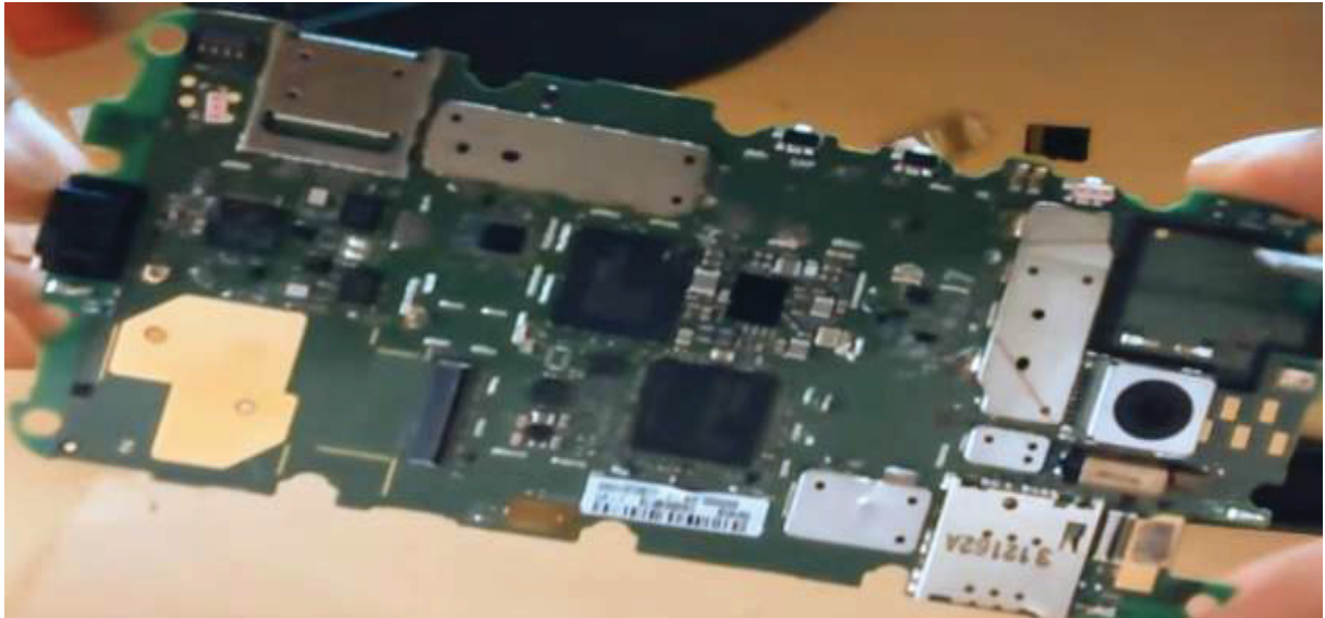
Figura 11 – Placa de Circuito Impresso sem shield / processador Moto G XT1033 (Moto G 1ª geração)
