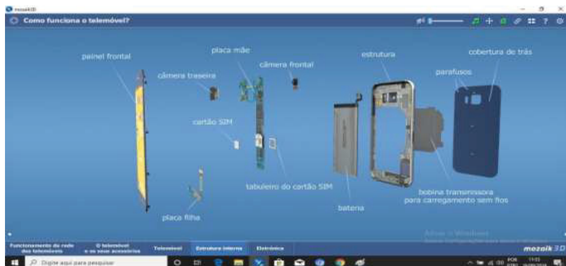
Figura 34 – Como funciona o telefone móvel IV (estrutura interna)
