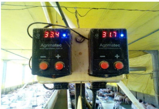
FIGURA 11 – Sistema automático de regulagem de temperatura interna. Fonte: Arquivo pessoal. Copagril/2017.
