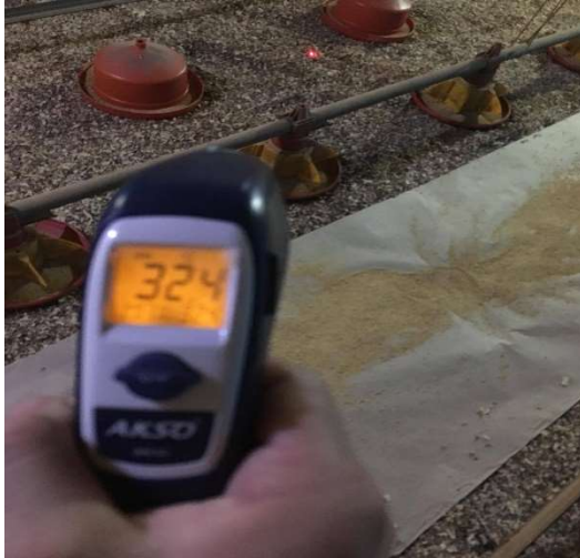
FIGURA 19 - TERMÔMETRO A LASER, MOSTRANDO A TEMPERATURA DA CAMA
