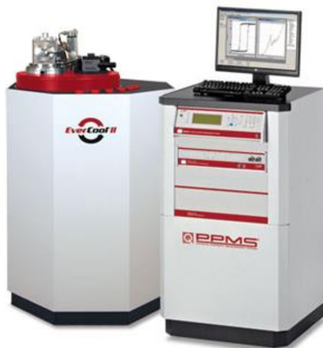
Figura 2.10: Fotografia do PPMS Evercool II da Quantum Design [51].
