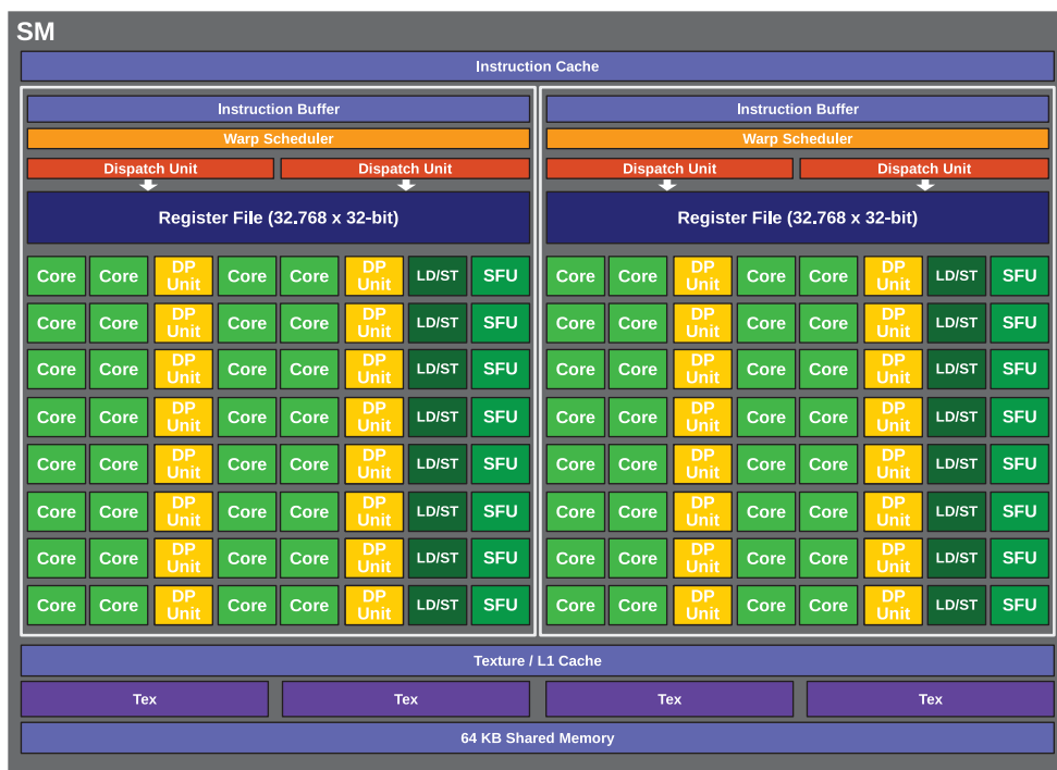
Figura 4.1: Componentes de um SM da arquitetura Pascal 6.0 [70].
