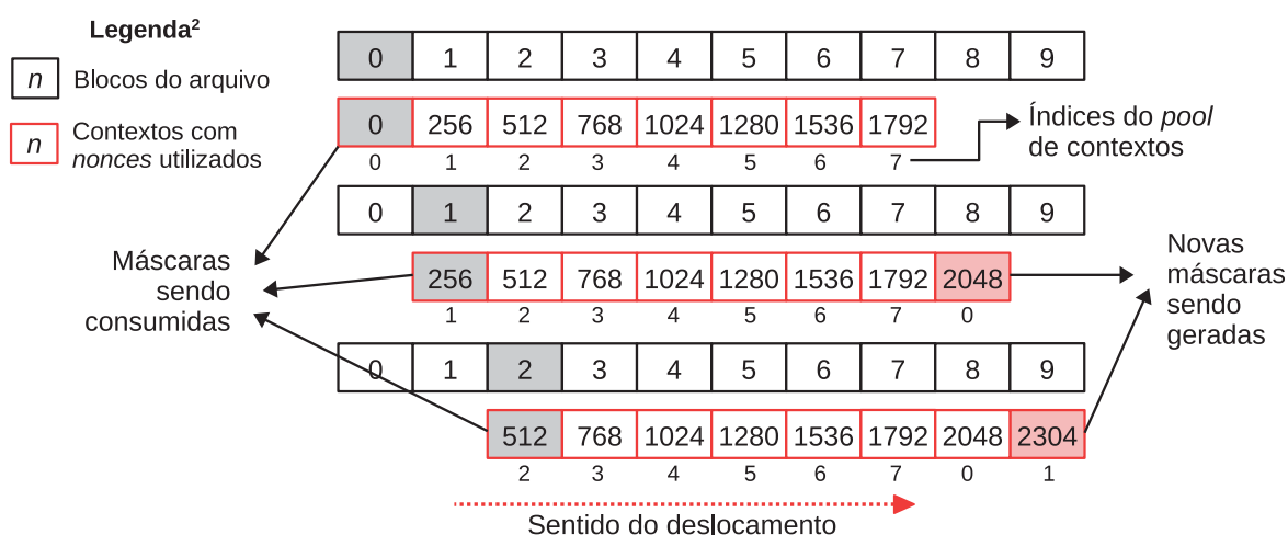
Figura 6.2: Pool de contextos para leitura e deslizamento da janela em leitura sequencial.
