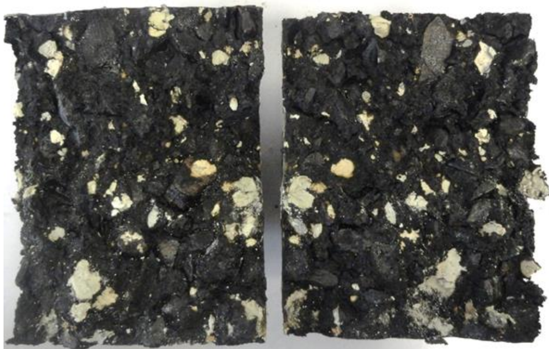
Figura 55 - CP rompido ensaio de resistência à tração (DUI) – mistura GM_ARC.
