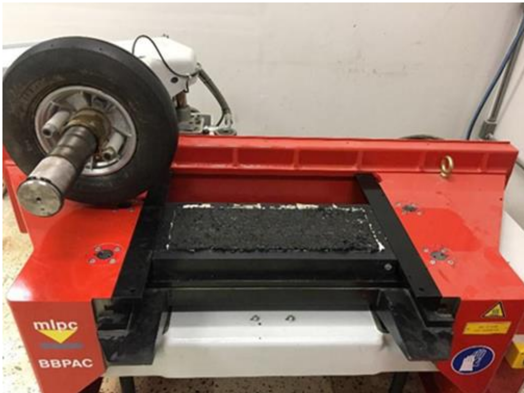
Figura 34 - Mesa compactadora de placas para ensaio de deformação permanente.
