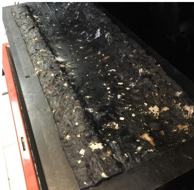
Figura 61 – Deformação excessiva logo após condicionamento mistura GM_ARC.
