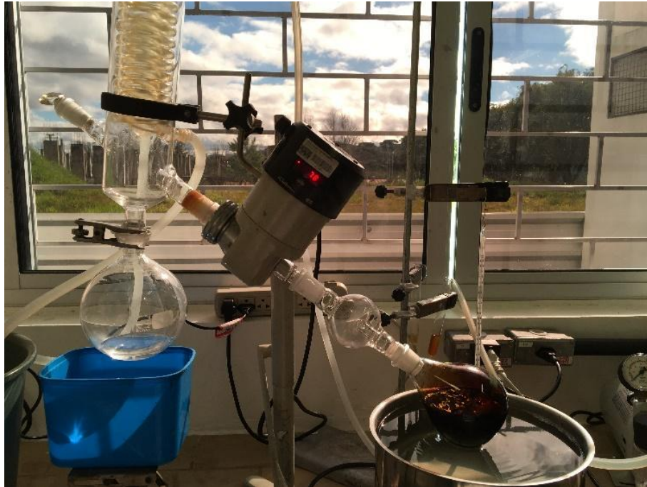
Figura 20 - Separação do solvente e do CAP utilizando o Rotoevaporador.
