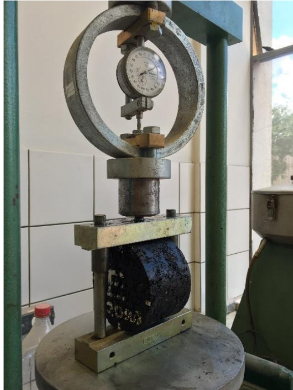
Figura 30 - Prensa Marshall – determinação da resistência à tração estática.
