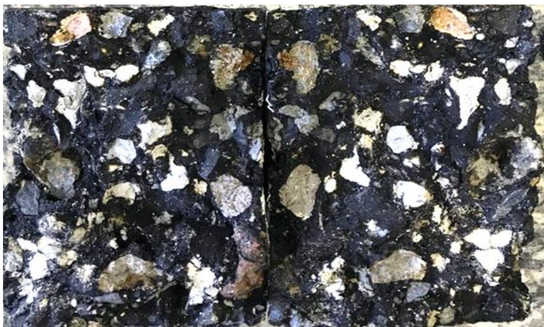
Figura 56 - CP rompido ensaio de resistência à tração (DUI) – mistura GARC_MRAP.
