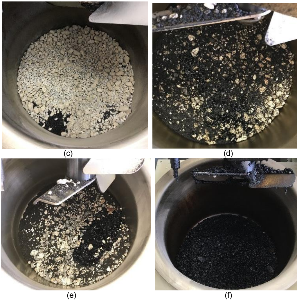
Figura 26– (a) RAP temp. ambiente; (b) RAP aquecido por 15 minutos; (c) incorporaç o de ARC; (d) mistura dos agregados 200s; (e) adiç o de ligante virgem; (f) mistura completa 500s.
