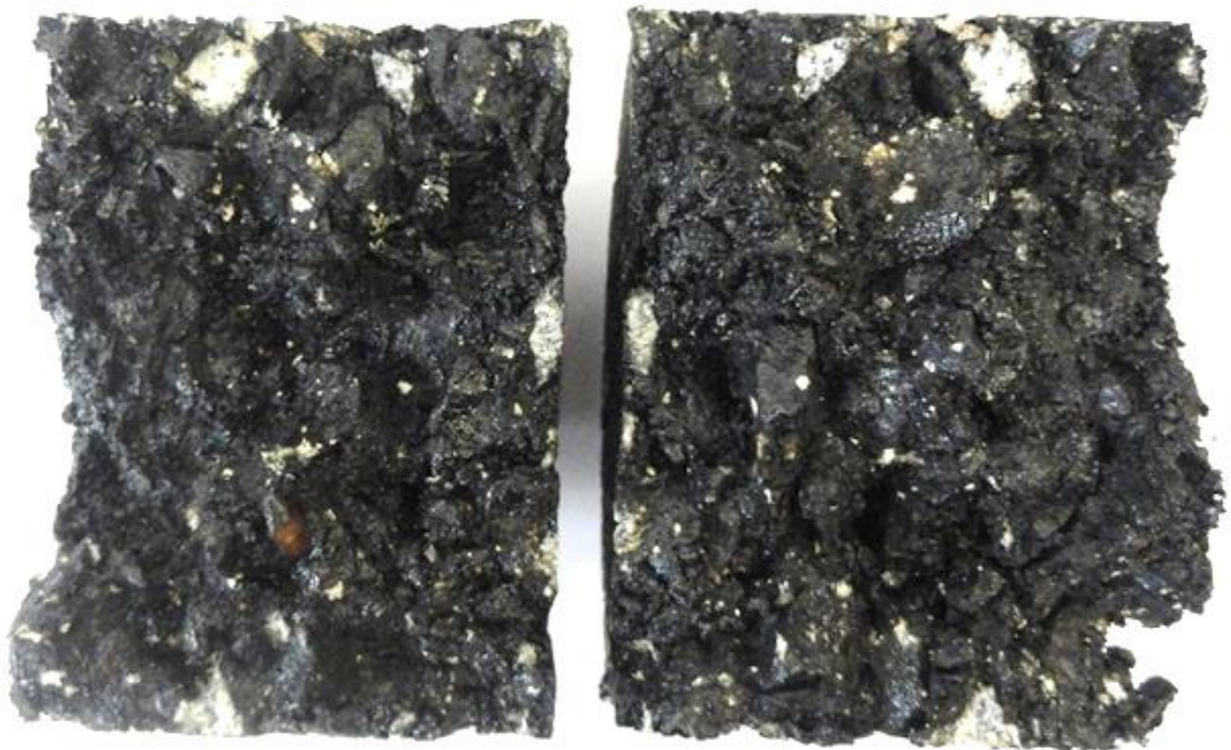
Figura 53 – CP rompido ensaio de resistência à tração (DUI) – mistura REF.
