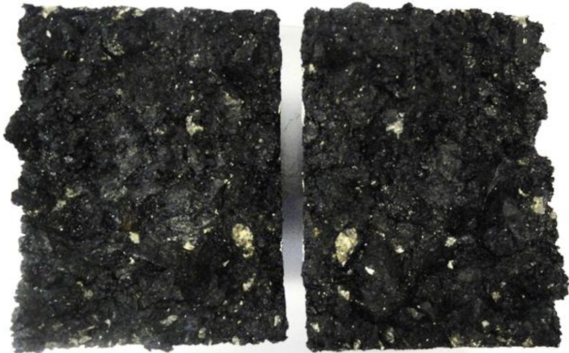
Figura 54 - CP rompido ensaio de resistência à tração (DUI) – mistura GM_RAP.
