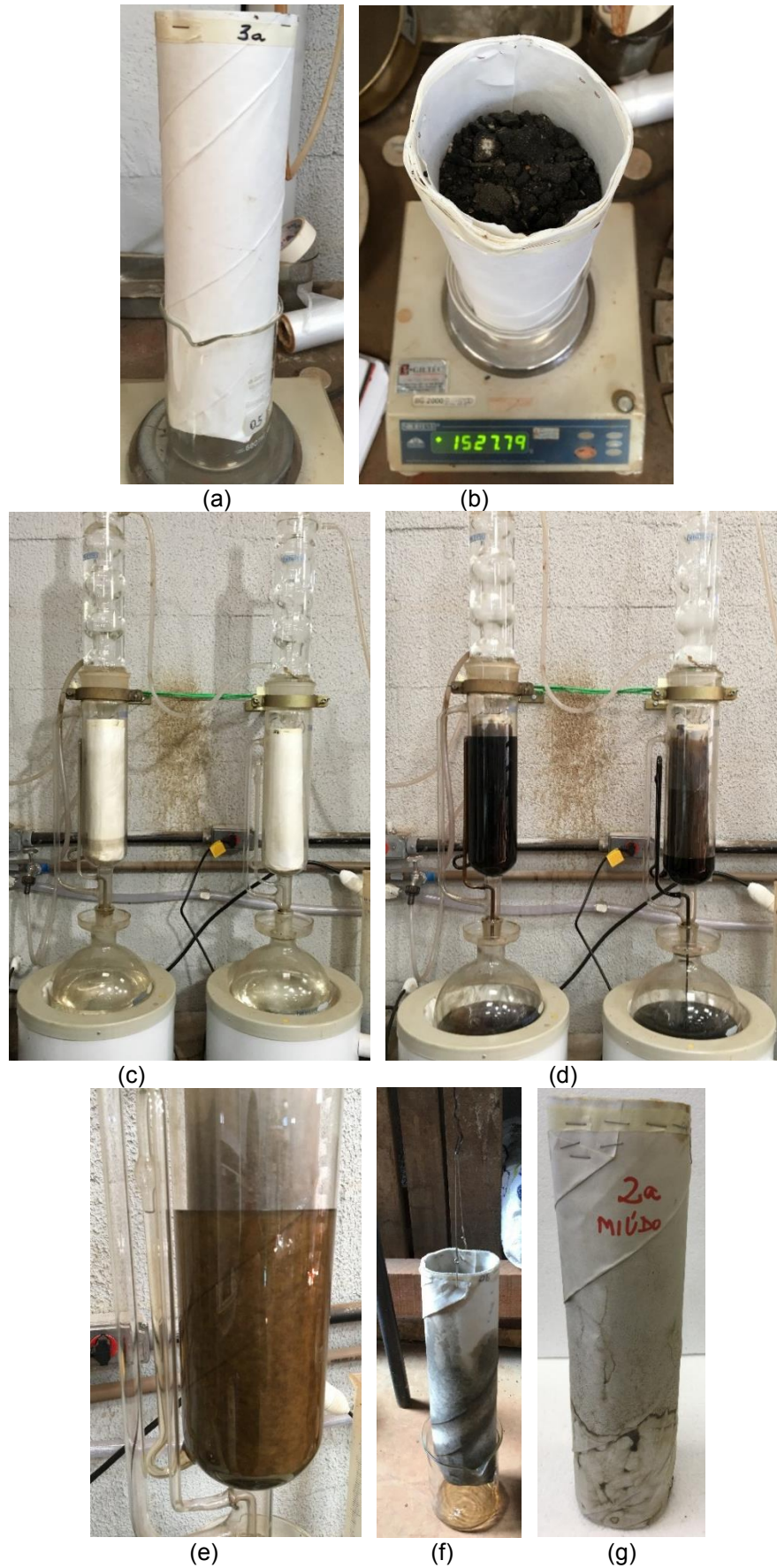
Figura 17 - (a) molde de papel filtro; (b) colocação amostra no molde; (c) extrator Soxhlet com amostra e solvente; (d) extração em andamento; (e) etapa final de extração-solvente límpido; (f) secagem superficial; (g) amostra após secagem em estufa.
