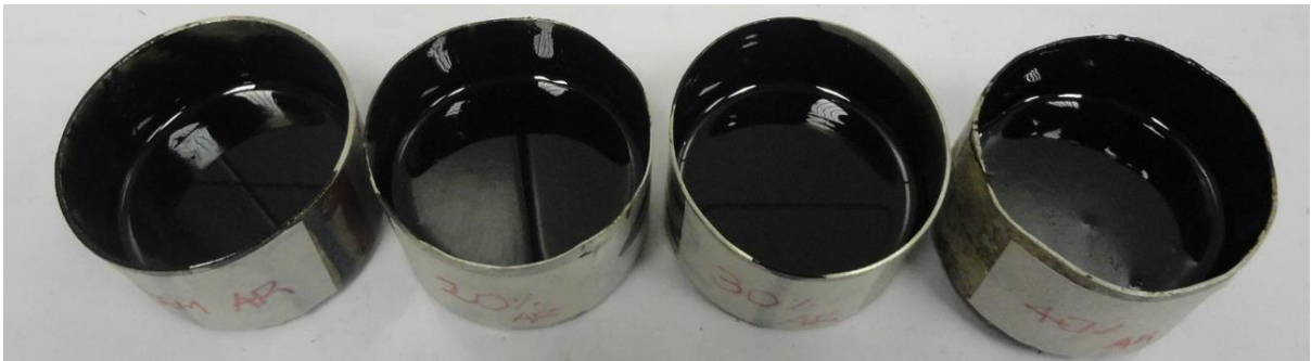
Figura 21 – Ligante recuperado RAP com adição de AR em teores de 20 a 40%.
