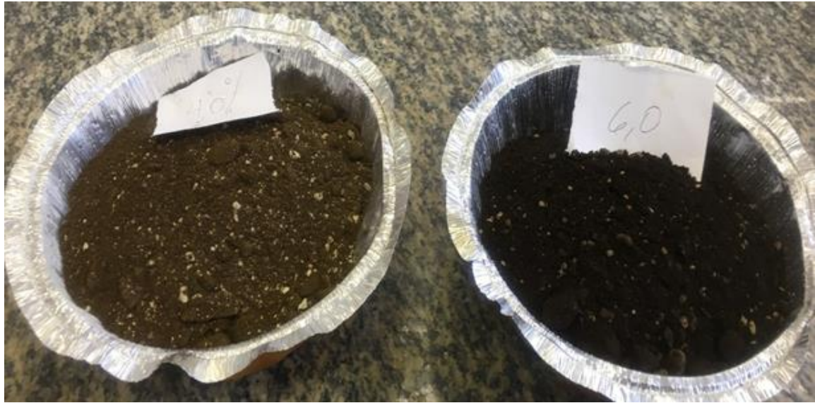
(a) (b) Figura 22 - Agregados com falta de recobrimento do ligante - mistura ARC- (a) teor de ligante 4,0%; (b) teor de ligante 6,0%.
