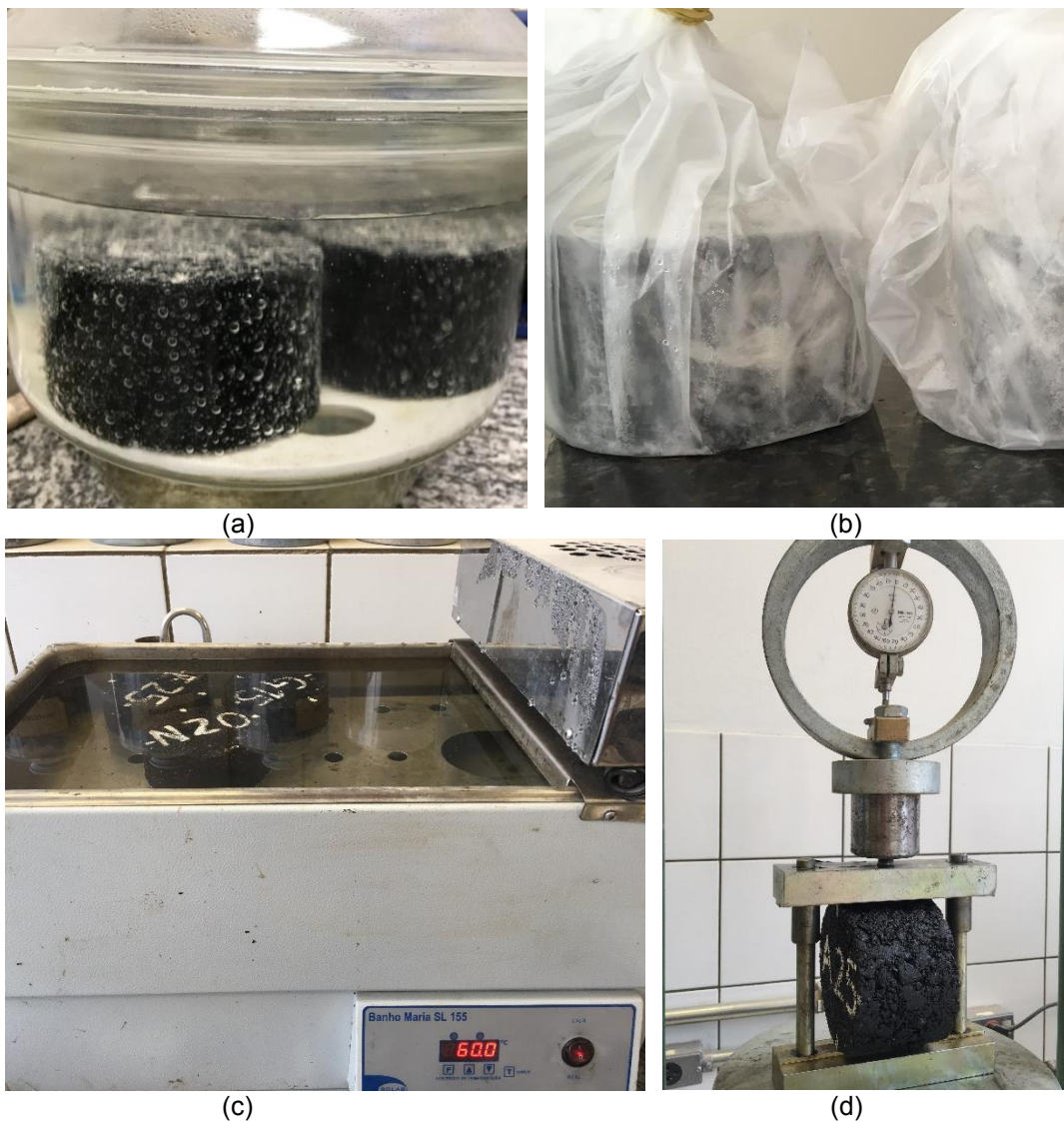
Figura 36 - (a) saturação parcial CP's; (b) congelamento (-18°C) por 16h; (c) banho a 60°C por 24h; (d) rompimento CP resistência à tração.
