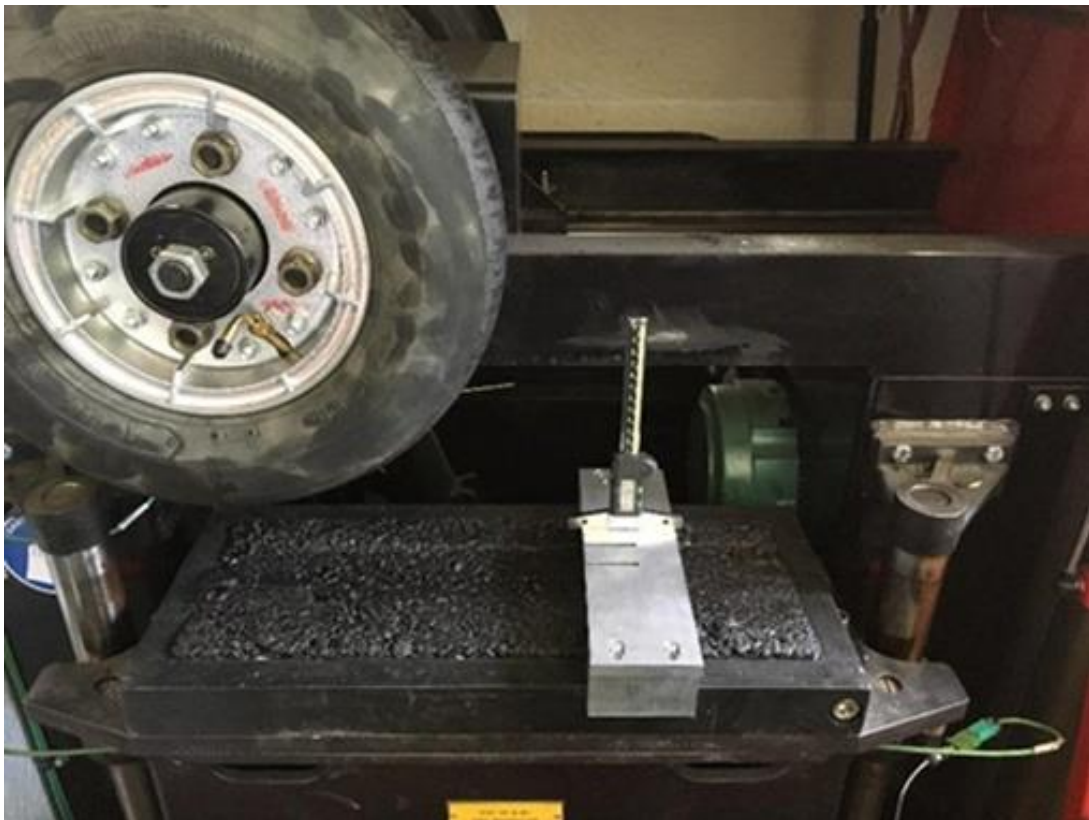
Figura 35 - Registro dos afundamentos – ensaio de deformação permanente.
