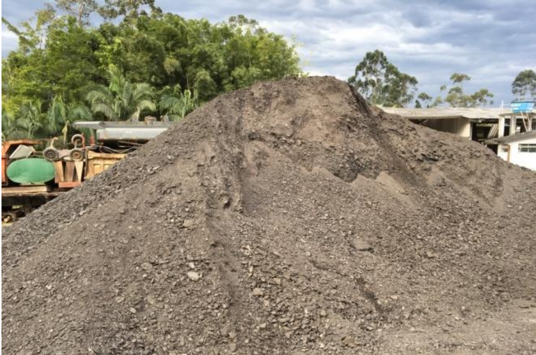
Figura 11 - Depósito de material fresado (local de coleta).
