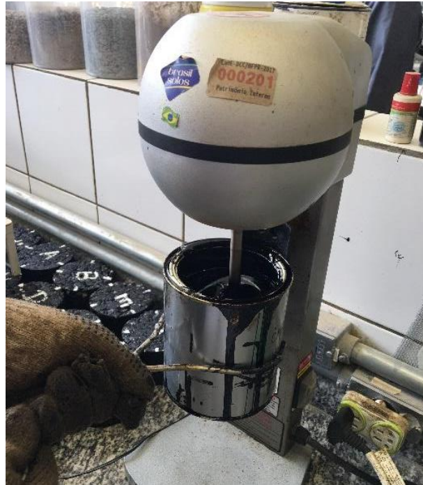
Figura 27 - Equipamento utilizado para mistura mecânica do ligante com o aditivo surfactante.
