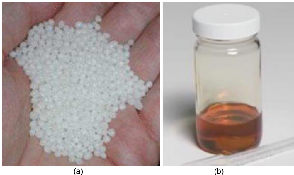
(a) (b) Figura 7 – Aditivos para mistura morna (a) ceras (b) surfactante. Fonte: Motta, 2011.
