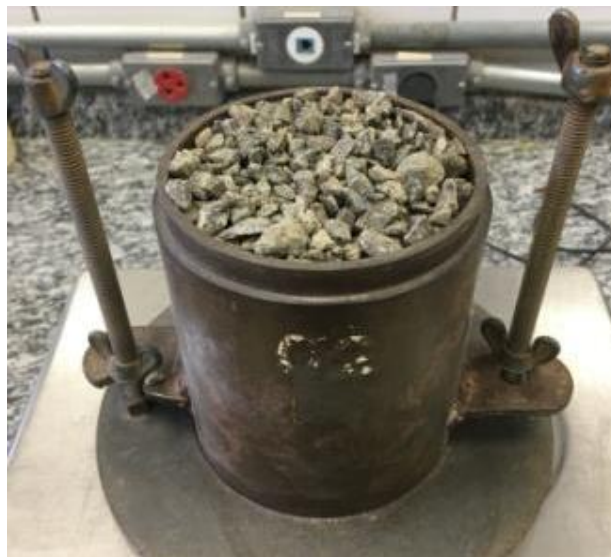
Figura 19 - Determinação massa unitária solta e compactada - RAP graúdo após extração.
