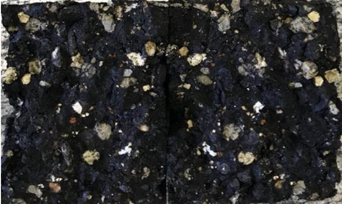
Figura 57 - CP rompido ensaio de resistência à tração (DUI) – mistura GRAP_MARC.
