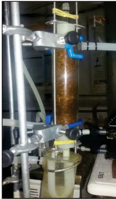
FIGURA12. REATOR DE LEITO FIXO UTILIZADO NATRANSESTERIFICAÇÃO DO ÓLEO DE MAMONA CATALISADA PELOSÓLIDO FERMENTADO CONTENDO A LIPASE DE *Burkholderia contaminans*
