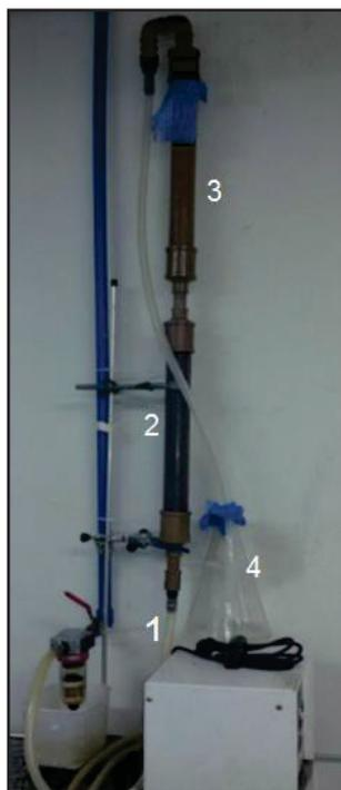
FIGURA 11. SISTEMA DE SECAGEM DO SÓLIDO FERMENTADO EM COLUNA COM FLUXO DE AR SECO
