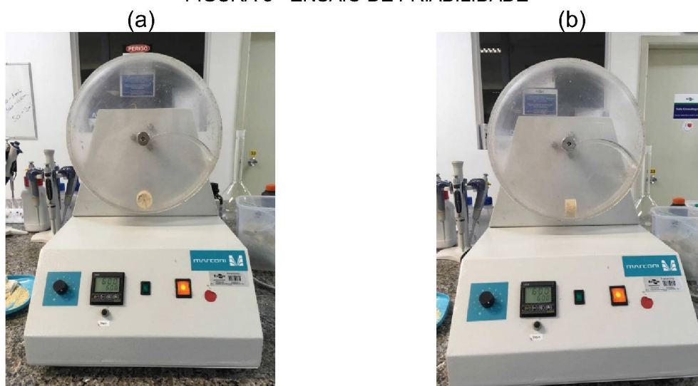
FIGURA 5 - ENSAIO DE FRIABILIDADE
