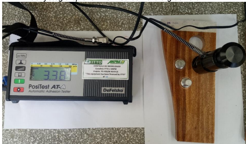
FIGURA 214. EQUIPAMENTO UTILIZADO PARA O ENSAIO PULL-OFF EM MADEIRA DE Brachystegia spiciformis E Julbernardia globiflora
