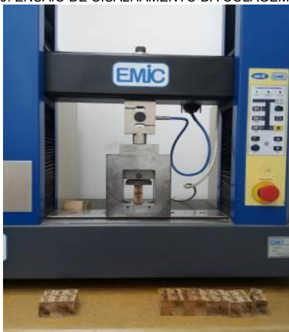
FIGURA 170. ENSAIO DE CISALHAMENTO DA COLAGEM LATERAL
