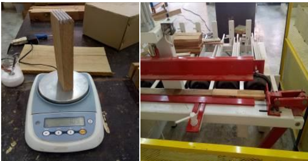
FIGURA 15. SARRAFOS DE Brachystegia spiciformis E Julbernardia globiflora UTILIZADOS PARA A MONTAGEM DE JUNTAS FINGER JOINTS
