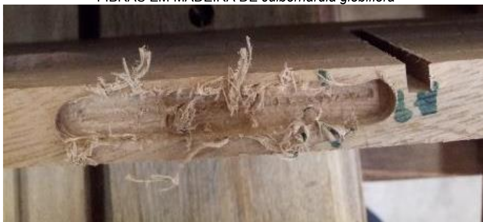
FIGURA 14. RASGO COM PRESENÇA DE ARREPIAMENTO E ARRANCAMENTO DAS FIBRAS EM MADEIRA DE Julbernardia globiflora
