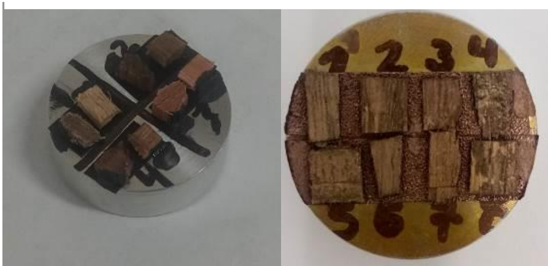
FIGURA 18. AMOSTRA SEM COBERTURA (A ESQUERDA) E AMOSTRA RECOBERTA COM OURO (A DIREITA) DA SUPERFÍCIE COLADA NA COLAGEM LATERAL DAS ESPÉCIES Brachystegia spiciformis E Julbernardia globiflora
