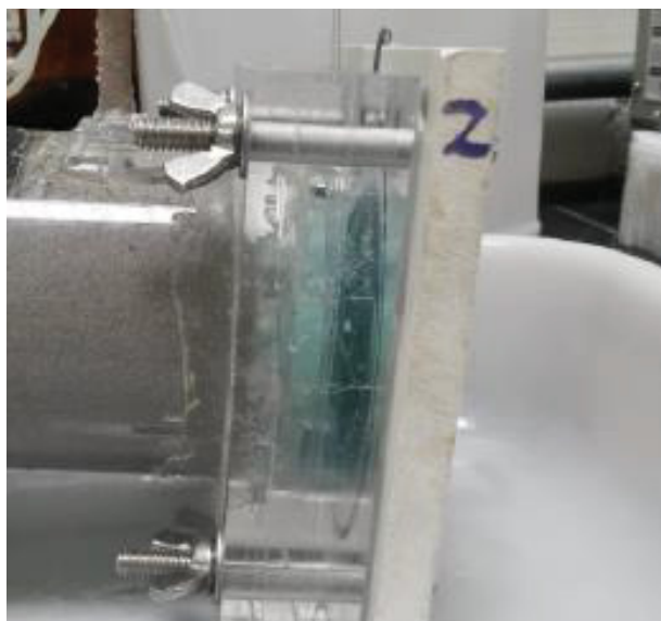
FIGURA 21 - CÂMARA CATÓDICA DO TESTE 1 AO FINAL DA REMEDIAÇÃO
