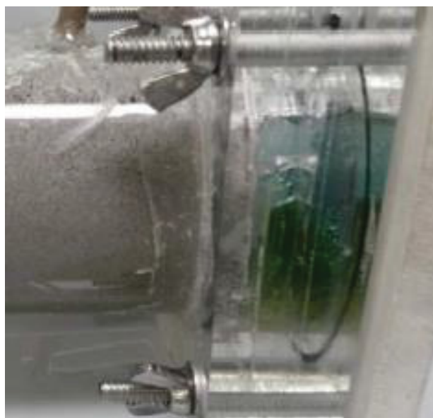
FIGURA 20 - CÂMARA CATÓDICA DO TESTE 1 LOGO APÓS 18 H DE REMEDIAÇÃO.
