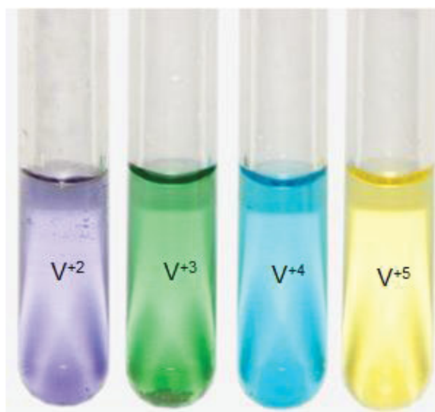
FIGURA 9 – SOLUÇÕES CARACTERÍSTICAS PARA OS ESTADOS DE OXIDAÇÃO DO VANÁDIO
