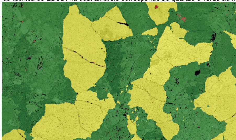
Figura 33 - Imagem por contraste de bandas (mapa de contorno de grãos) do agregado gráudo obtida por meio da técnica de EBSD, na qual amarelo corresponde ao quartzo e verde ao microclínio.
