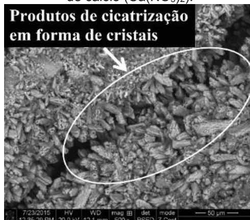
Figura 11 – Produtos de cicatrização, carbonatos de cálcio ( \text{CaCO}_3 ) e silicato de cálcio hidratado (C-S-H), em argamassas fissuradas contendo 0,85% de microcápsulas de ureia-formaldeído com nitrato de cálcio ( \text{Ca}(\text{NO}_3)_2 ).
