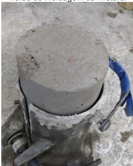
Figura 39 - Aspecto do corpo de prova de concreto contendo 6% de nanocápsulas de sílica após 24 horas de moldagem da mistura.
