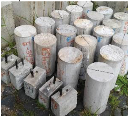
Figura 22 - Corpos de prova de concreto expostos em ambiente externo.
