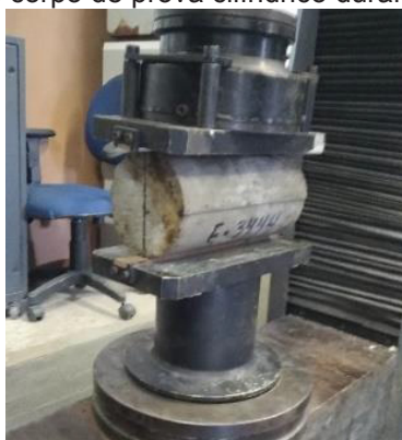
Figura 25 - Posicionamento de corpo de prova cilíndrico durante procedimento de fissuração.
