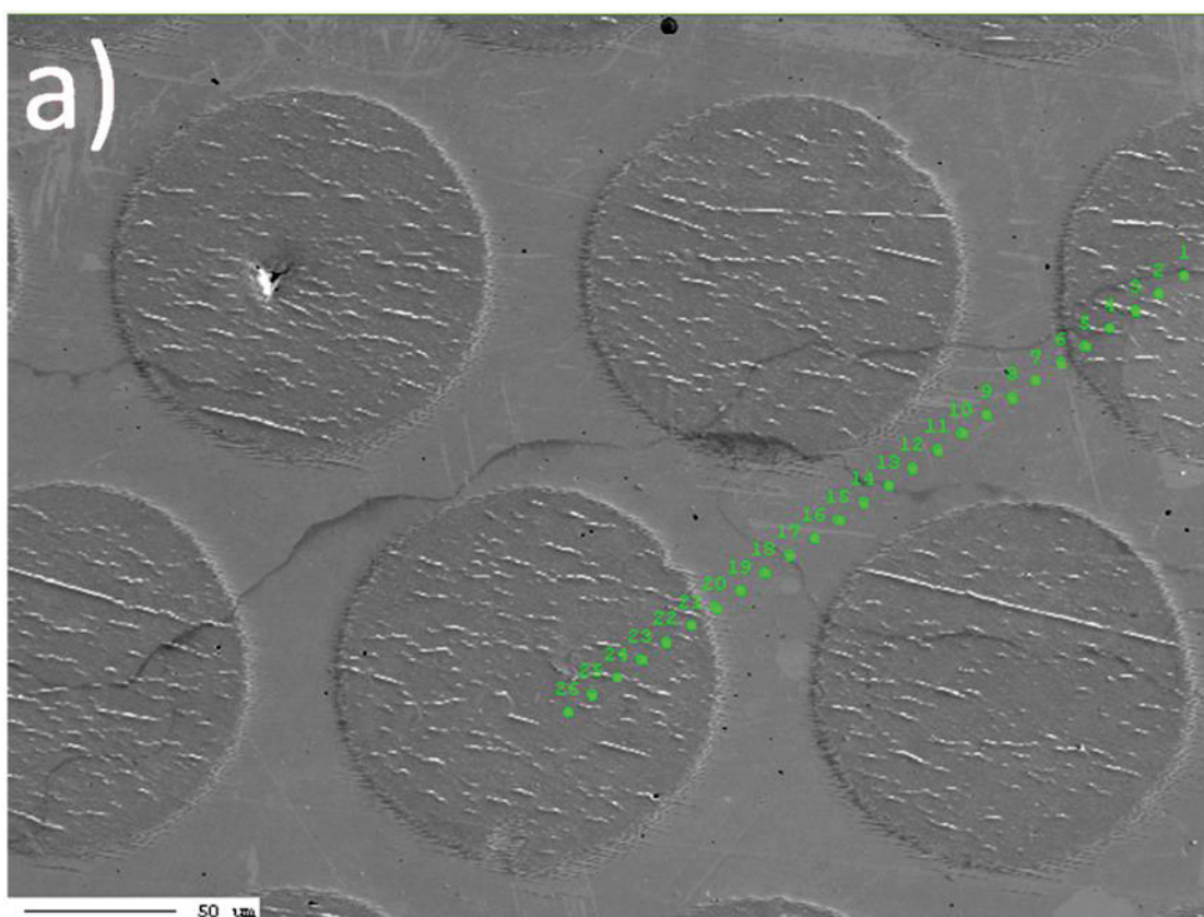
FIGURA 73 - EPMA DA AMOSTRA COM 10 wt.% Al NITRETADA POR PLASMA ECR DURANTE 4 h NA TEMPERATURA DE 350 °C COM MISTURA GASOSA COMPOSTA POR 60% DE N 2 + 40% H 2 . a) REGIÃO ANALISADA E b) PERFIL DE NITROGÊNIO E DE ALUMÍNIO.
