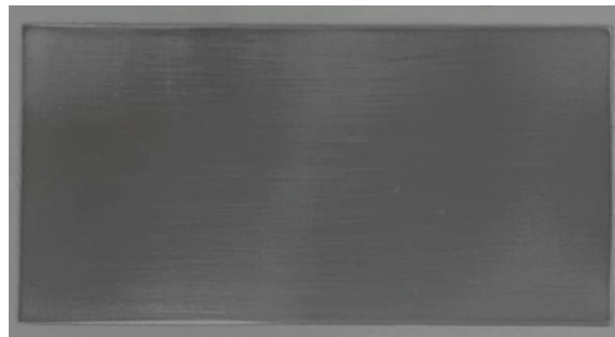
FIGURA 13 – Fotografia de uma amostra aço AISI 1020 no formato de chapa retangular (10 x 5 x 0,1) cm, formato apropriado para a aplicação de revestimentos com o auxílio de um extensor.
