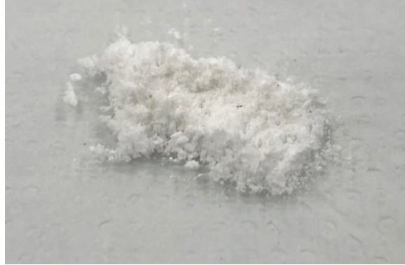
FIGURA 14 – Fotografia das cápsulas de CMC-Na contendo o inibidor de corrosão BTA utilizadas no preparo do revestimento epoxídico inteligente.
