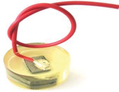
FIGURA 12 – Fotografia de uma amostra de aço AISI 1020 embutida em molde de resina epoxídica.
