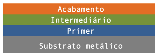
FIGURA 1 - Representação de um esquema geral de pintura sobre um substrato metálico: primer , intermediário e acabamento.
