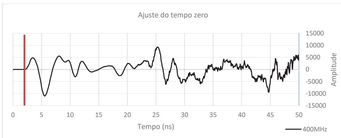
FIGURA 7: Ajuste do tempo zero indicado pela linha em vermelho (2,5ns) aplicado sob o traço do radargrama.
