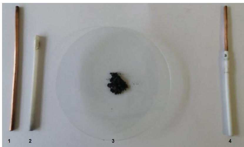
Figura 9: COMPONENTES UTILIZADOS PARA A CONSTRUÇÃO DOS ELETRODOS DE PASTA DE CARBONO
