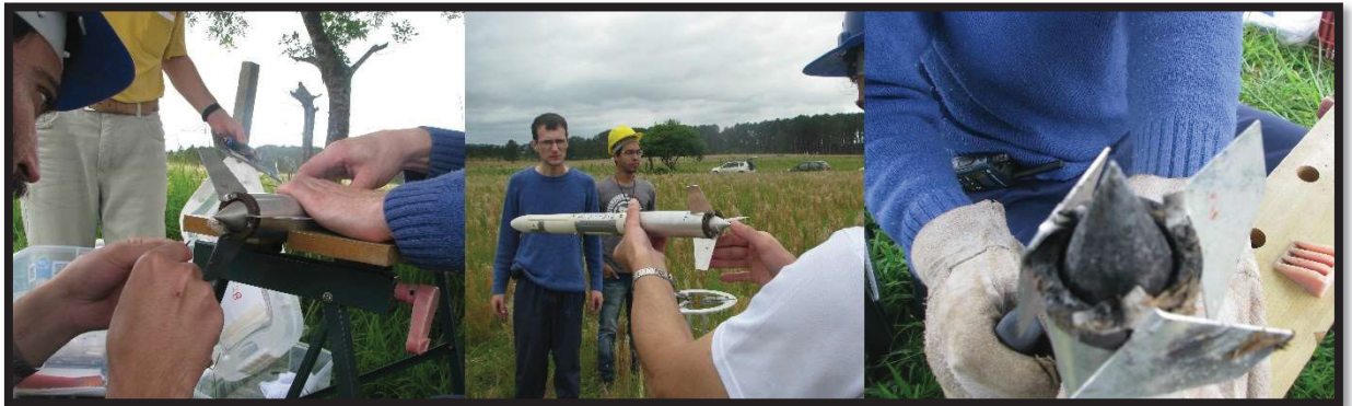
Figura 35 – Preparação do foguete (a) verificação final do alinhamento geral do foguete (b) motor-foguete após o voo P-23 (c)
