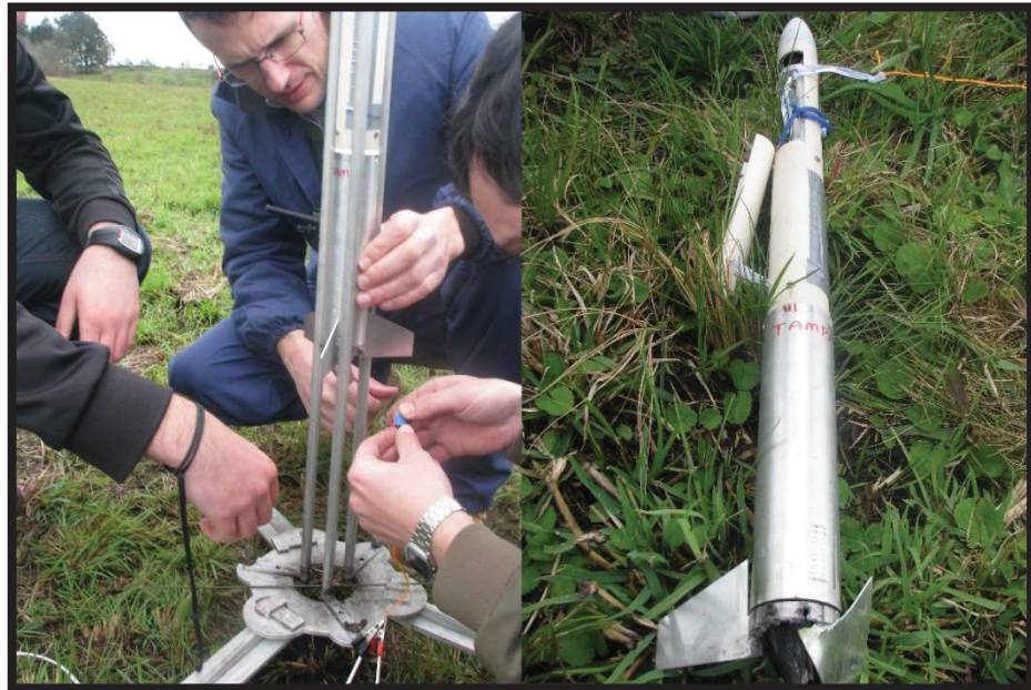
Figura 31 – (a) preparo do foguete na rampa de lançamento e (b) foguete após o voo P-21 com avaria próximo ao motor
