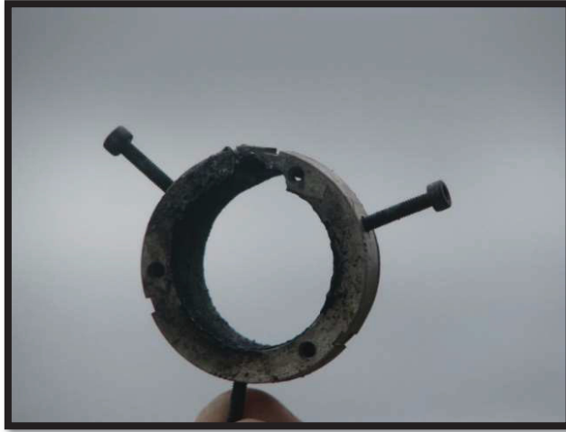
Figura 32 – Conector do PLUG avariado durante o voo P-21
