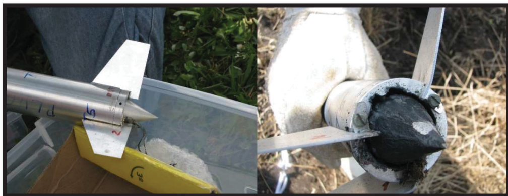
Figura 34 – Motor alinhado antes do voo (a) Conector do PLUG avariado após o voo P-22 (b)
