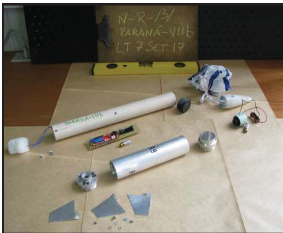
Figura 24 – Cápsula Paraná 7 e motor Netuno-R- \beta com todos os seus componentes
