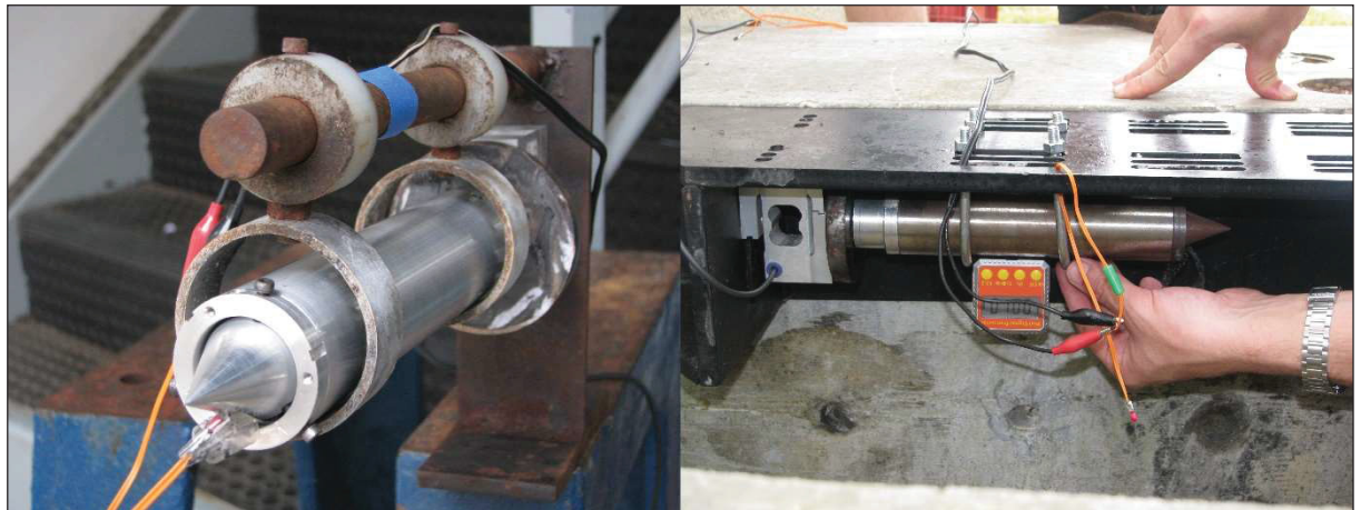
Figura 21 – Bancadas, (a) móvel e (b) bancada fixa usadas pelo GFCS
