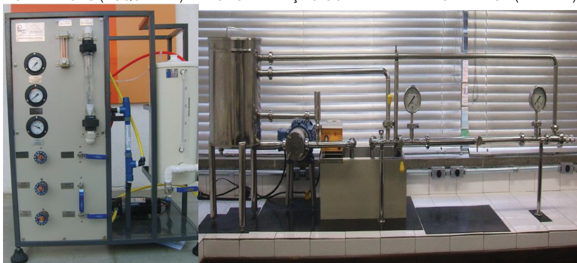
FIGURA 4.2 — UNIDADES EXPERIMENTAIS DE MICRO E ULTRAFILTRAÇÃO COM MEMBRANAS POLIMÉRICAS (ESQUERDA) E MICROFILTRAÇÃO COM MEMBRANA CERÂMICA (DIREITA).
