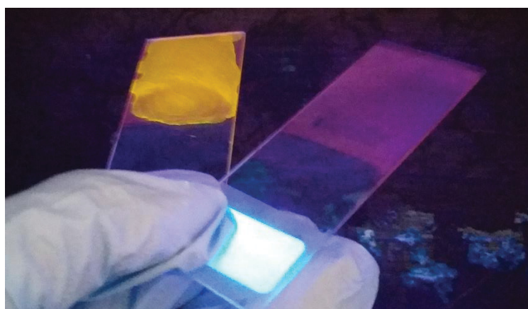
FIGURA 36 - FOTOGRAFIA DOS SUBSTRATOS DE VIDRO, AMBOS COM AuNPs ANCORADAS. A LÂMINA COM COLORAÇÃO LARANJA DIZ RESPEITO AO NANOCOMPÓSITO OBTIDO POR CASTING (5 DEPOSIÇÕES DE LaPPS87).
