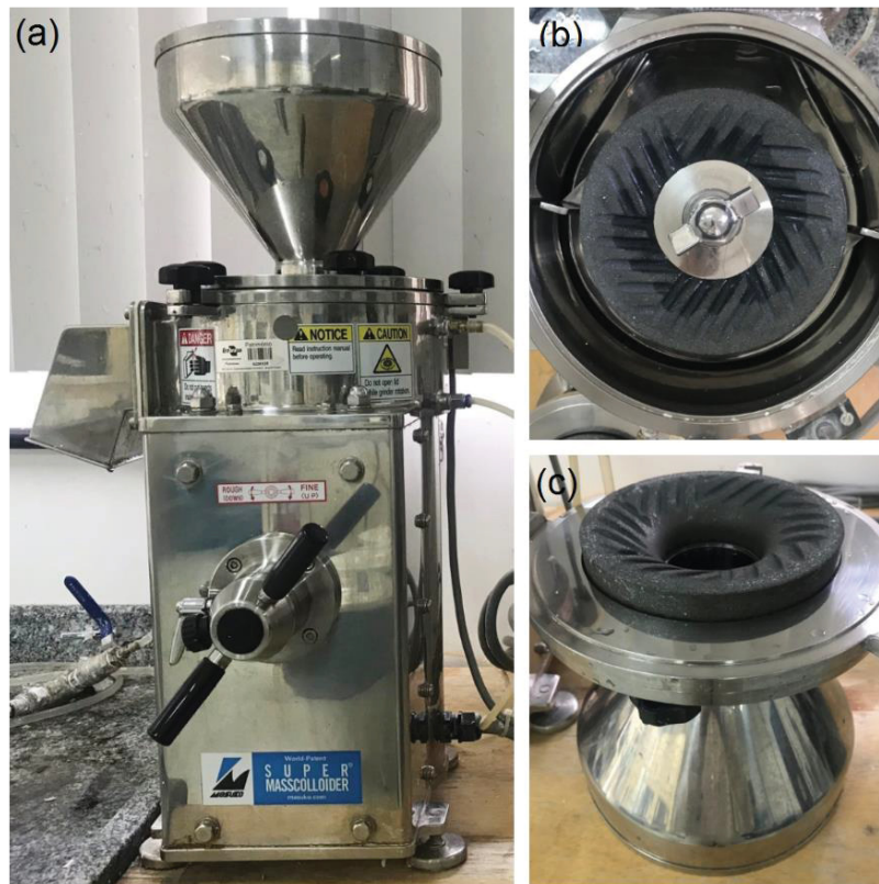
FIGURA 15 – (a) MOINHO SUPERMASSCOLLOIDER MODELO MKCA6-2; (b) DISCO ROTACIONAL; (c) DISCO ESTÁTICO
