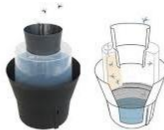
Figura 6 - Armadilha Gravid Aedes Trap. Fonte: Biogents (2018)
