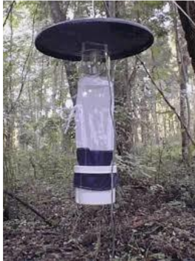
Figura 8 - Armadilha CDC Light Trap instalada em campo. Fonte: CMMCP (2018).
