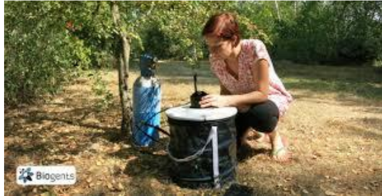
Figura 5 - Armadilha Bg-Sentinel com seus componentes e instalada em campo. Fonte: BG Sentinel (2018).
