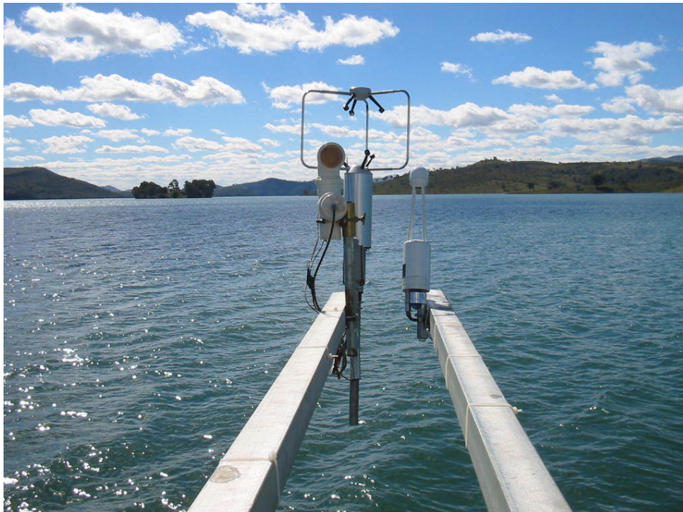
Figura 4.4: Configuração dos equipamentos após o Exfu-3, na estação micrometeorológica de Guapé: anemômetro Young 81000 e sonda Campbell Sci. CS500 no abrigo de PVC à esquerda; analisador de CO 2 /H 2 O Campbell Sci. Licor-7500 à direita.
