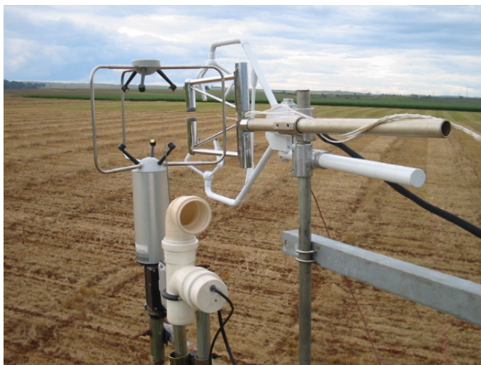
Figura 4.2: Configuração dos instrumentos utilizados no Exfu-2, na estação micrometeorológica de Ponta Grossa: anemômetro Young 81000 e sonda Campbell Sci. CS500 no abrigo de PVC (primeiro plano); anemômetro Campbell Sci. CSAT-3 e higrômetro infravermelho Campbell Sci. KH20 (segundo plano).
