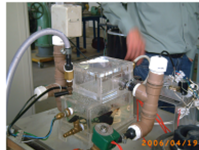
f) Higrostató para controle da umidade relativa do ar e sua posição ao alto e a esquerda do sistema
