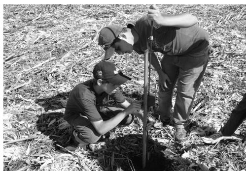
**Figura 4.** Determinação da resistência à penetração
