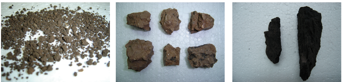
Figura 11: Alguns tipos de estrutura encontrados nos solos: granular (esquerda), blocos (centro) e colunar (direita). Fonte: Lima (2007).
