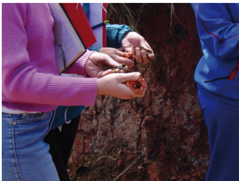
Figura 10: Determinação da textura do solo: sentir a sensação ao tato ao esfregar a amostra de solo molhada entre o polegar e o indicador. Foto: Marcelo Ricardo de Lima.
