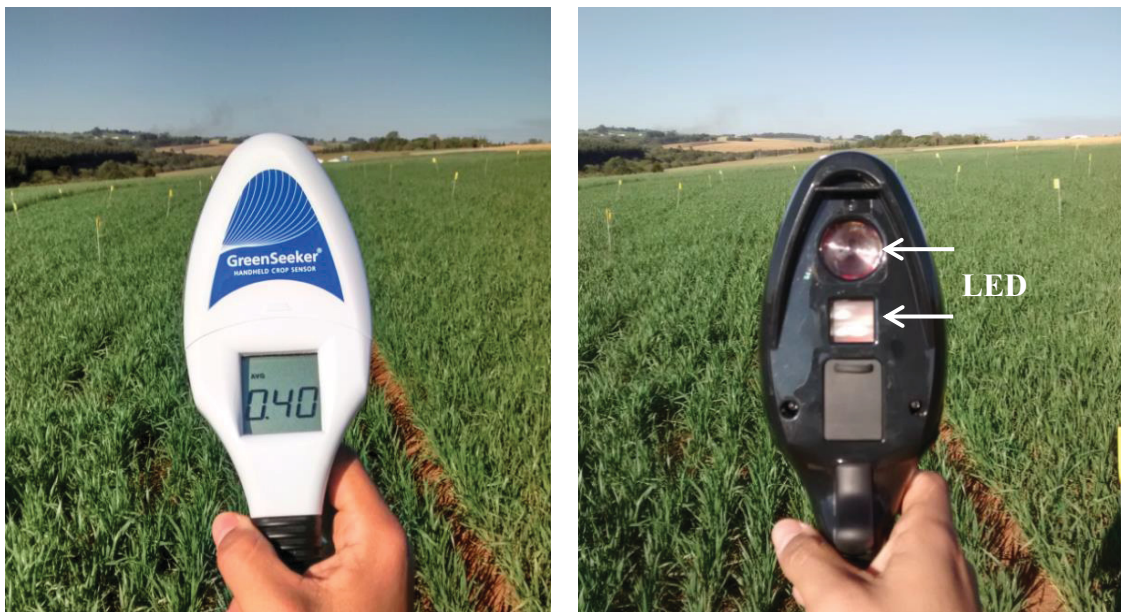
FIGURA 2. SENSOR ÓTICO ATIVO GREENSEEKER® HAND HELT™ COM DOIS TIPOS DE LED (“LIGHT EMITTING DIODES”) (LADO DIREITO) QUE EMITEM RADIAÇÃO ATIVA NO COMPRIMENTOS DE ONDA NO VERMELHO E RECEBE NO INFRAVERMELHO PRÓXIMO.
