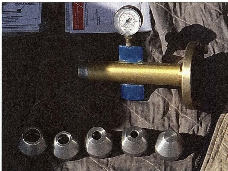
Figura 3 – Esguicho de jato compacto, com requinte adaptável de 13 a 32 mm
