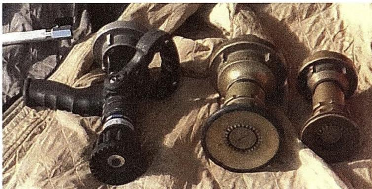
Figura 4 – Esguichos ajustáveis, à esquerda o tipo pistola de 38 mm, ao centro o comum de 63 mm e à direita o comum de 38 mm
