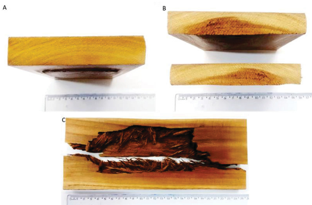
FIGURA 16 - ASPECTO IRREGULAR NO CENTRO DA PEÇA (A), RACHADURAS INTERNAS (B) E DESFIBRAMENTO EM MADEIRA DE Gmelina arborea DENSIFICADA ACIMA DE 180°C
