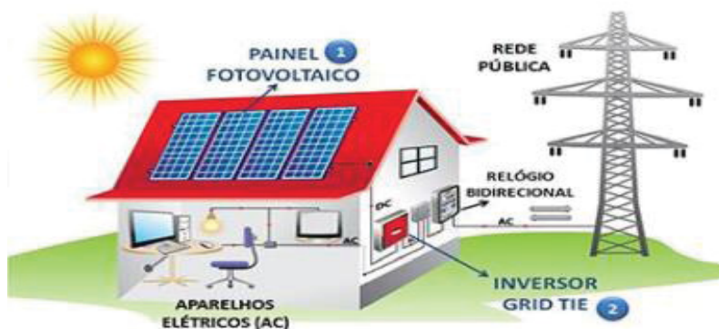
FIGURA 5 – SISTEMA CONECTADO À REDE ( Grid-tie )
