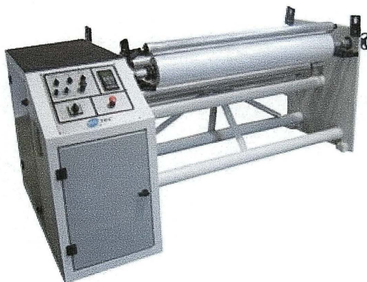
Figura 05 – Máquina picotadeira de plástico.
