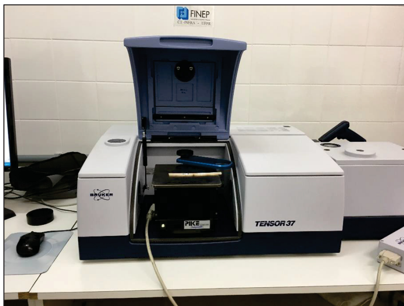
FIGURA 11. ESPECTROFOTÓMETRO DE REFLECTANCIA NIR BRUKER TENSOR 37
