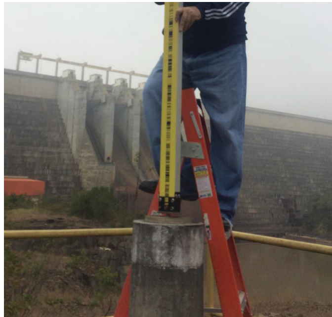
FIGURA 25 – POSICIONAMENTO DA MIRA NOS PILARES
