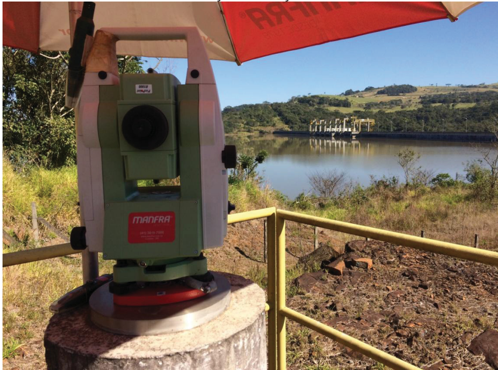
FIGURA 23 – INSTALAÇÃO ESTAÇÃO TOTAL NO PILAR
