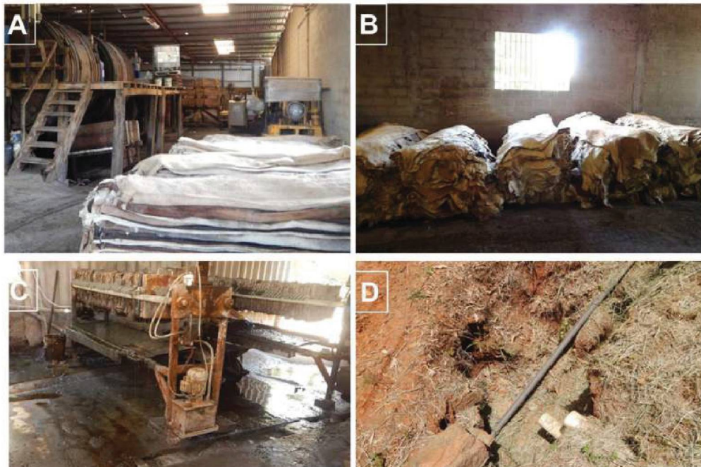
Foto 1 – Imagens do curtume da área de estudo. (A) setor da etapa de ribeira (preparo para o curtimento) - couros e fulões; (B) couros salgados empilhados; (C) setor pós-curtimento: infiltração no solo; (D) canos advindos da indústria com escoamento para a rua lateral (Fonte: o autor).
