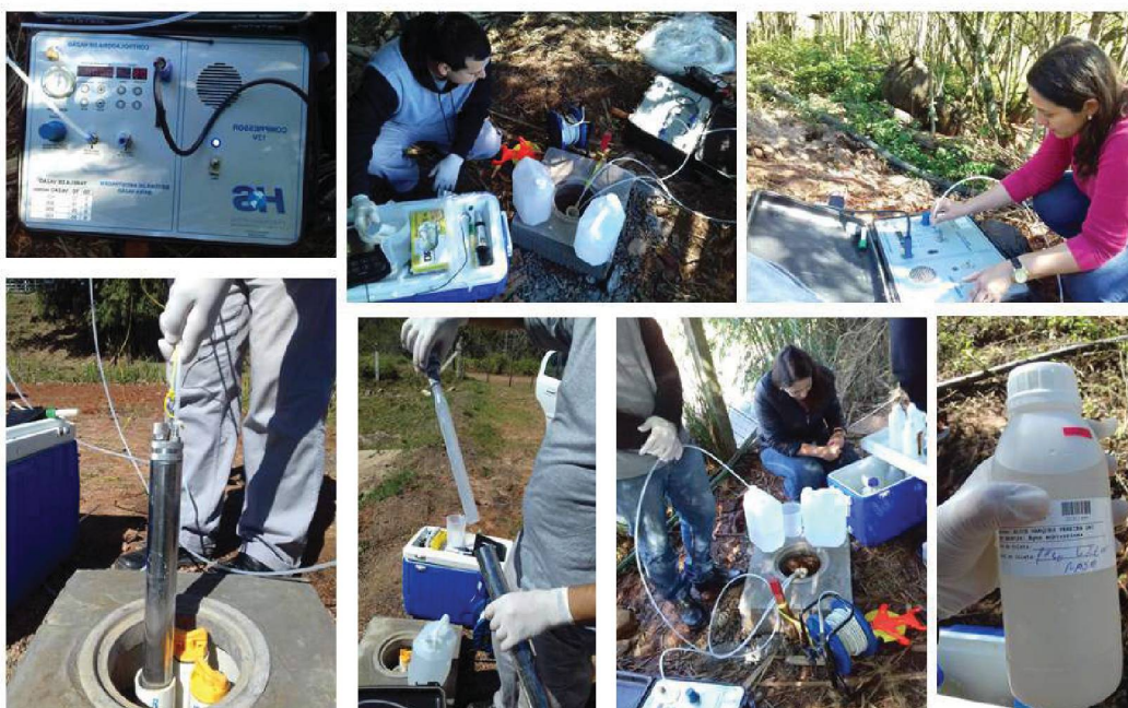
Foto 6 – Coletas de amostras de água subterrânea por método de baixa vazão.
