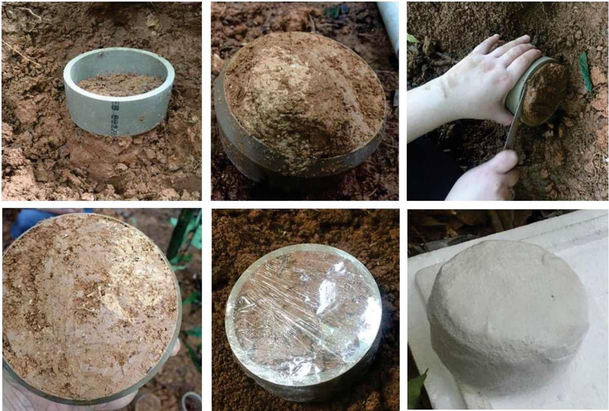
Figura 16 – Procedimento de coleta de amostras indeformadas
