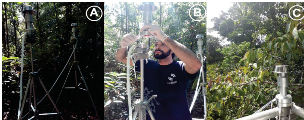
FIGURA 2 – AMOSTRADORES INSTALADOS E PROCEDIMENTO DE TROCA DE AMOSTRAS
