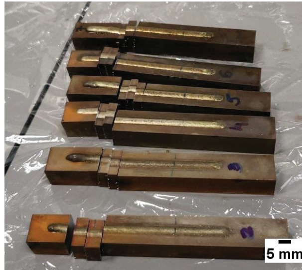
FIGURA 21 - AMOSTRAS CORTADAS COM 5 MM DE ESPESSURA PARA EMBUTIMENTO
