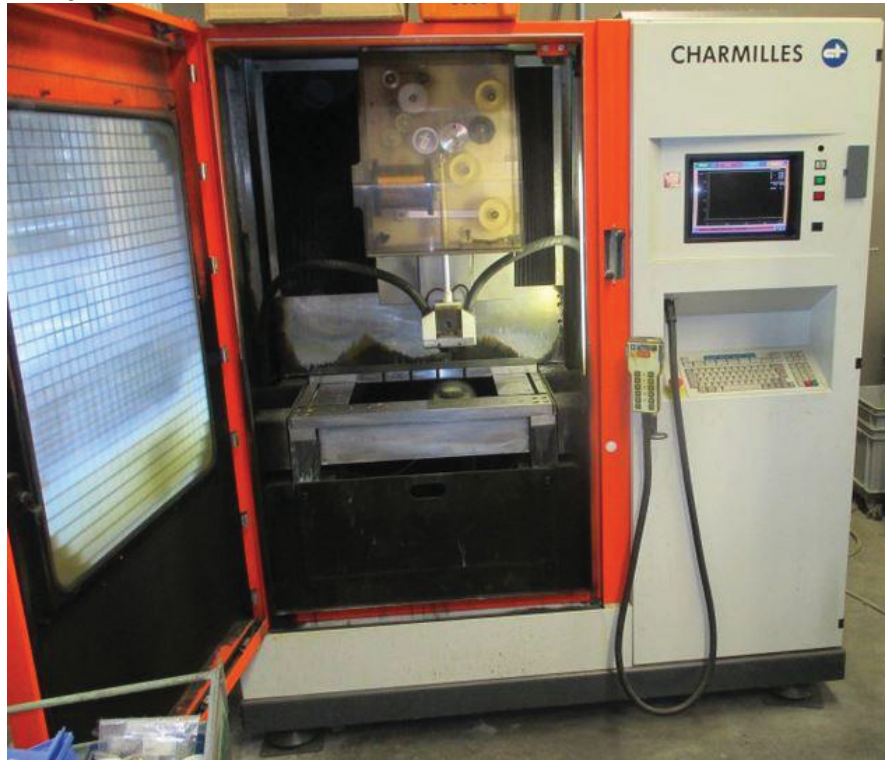
FIGURA 18 - EQUIPAMENTO DE CORTE POR ELETROEROSÃO CHARMILLES ROBOFIL 290P®
