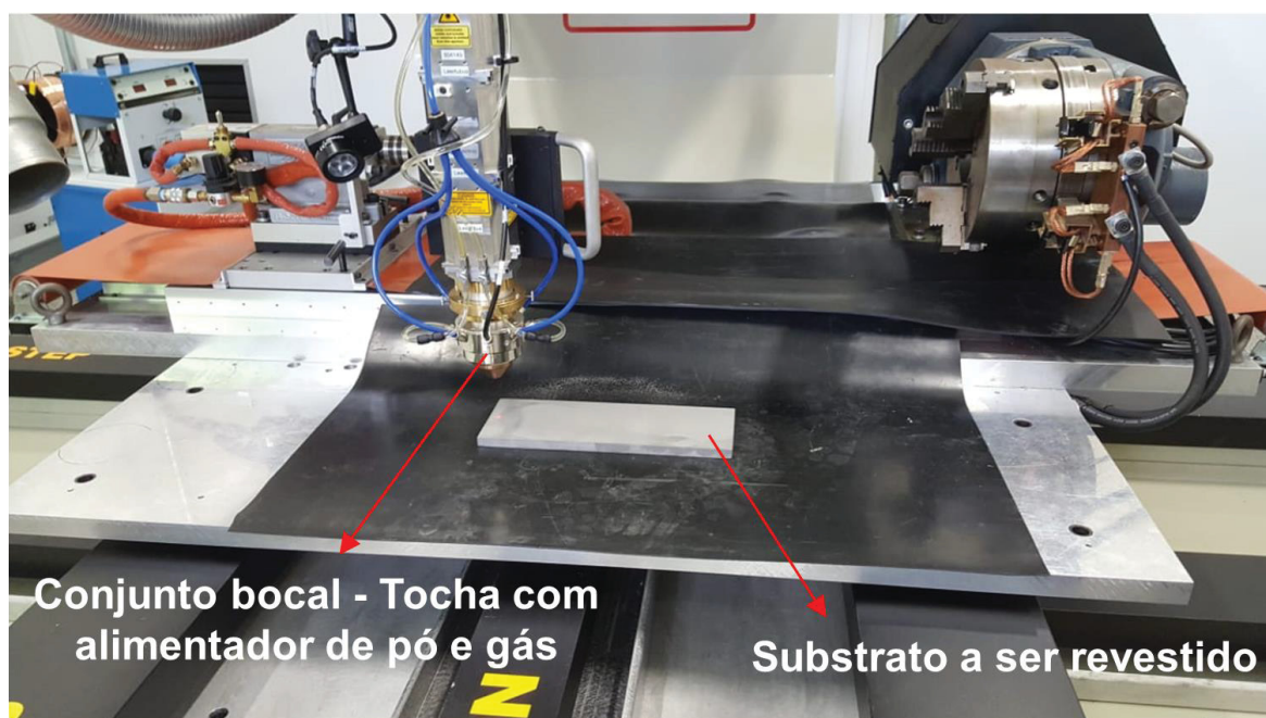
FIGURA 15 – EQUIPAMENTO PRECO - LASER CLADDING – PROCESSO DE DEPOSIÇÃO
