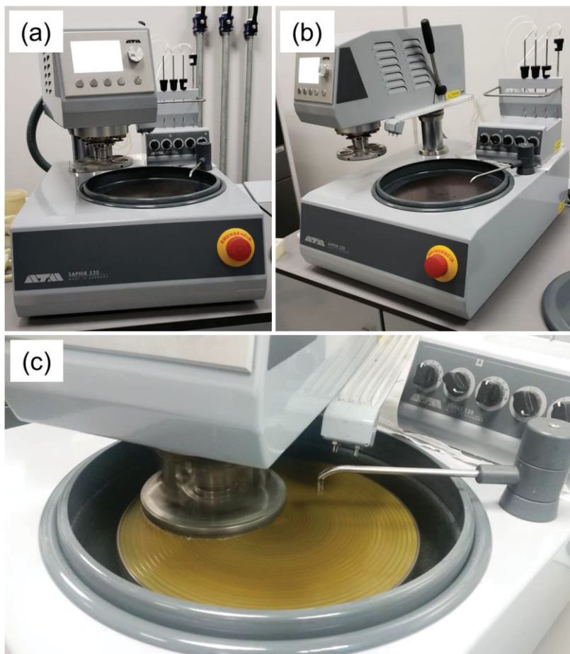
FIGURA 24 - ATM – SAPHIR 520 ® E TOPAS 130 ® - EQUIPAMENTO DE POLIMENTO DE AMOSTRAS EMBUTIDAS EM BAQUELITE
