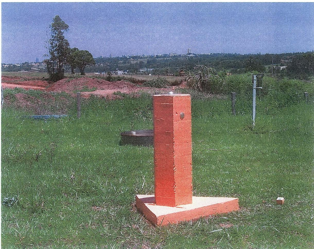
Figura 33 - Pilar com chapa de identificação fixada no seu corpo.
