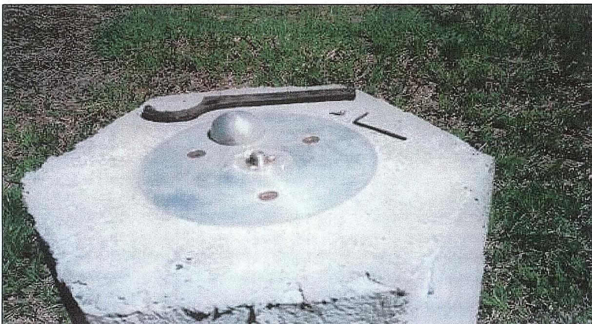
Figura 41 - Dispositivo de Centragem forçada padrão UFPR aberto.
