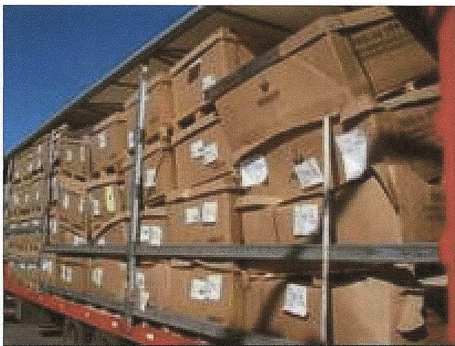
Figura 5 – Carreta saturada, mas caixas frágeis avariadas.
