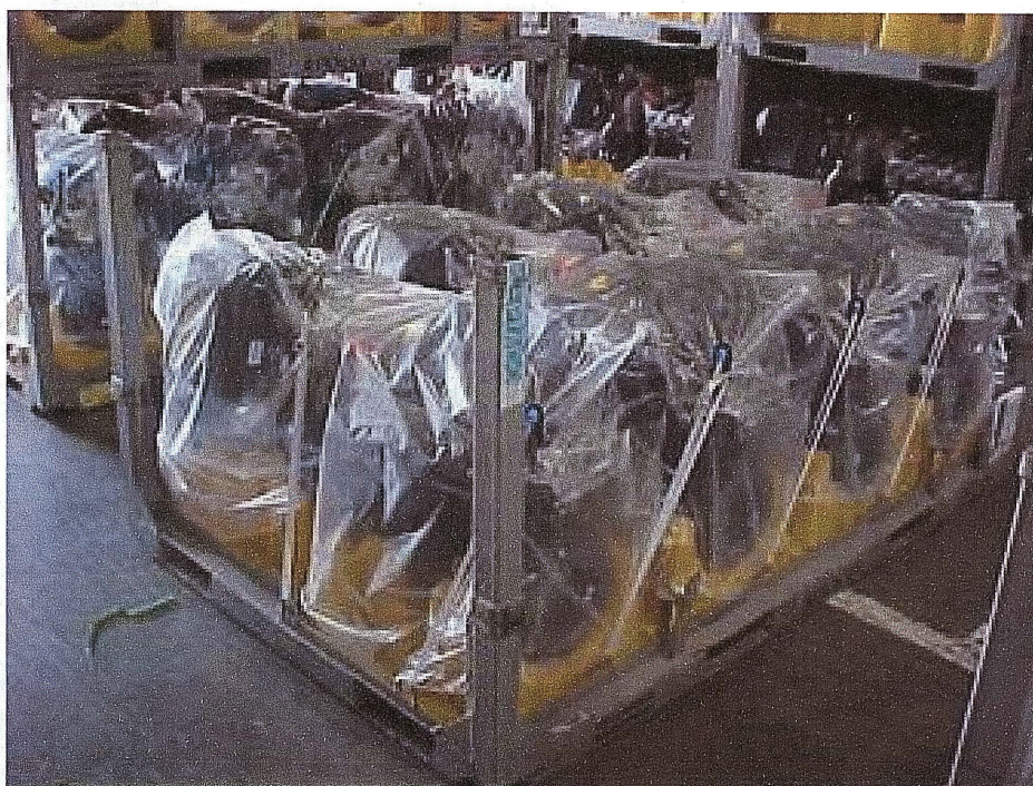
Figura 16 – Rack Metálico com motor e altura de 1000 mm
