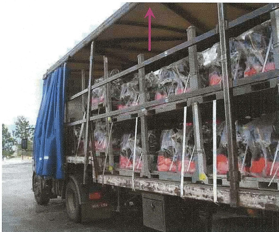
Figura 9 – Espaço não aproveitado sobre os racks dentro da carreta
