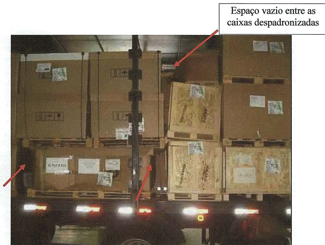
Figura 3 – Espaços vazios na carreta devido ao carregamento de embalagens não padronizadas
