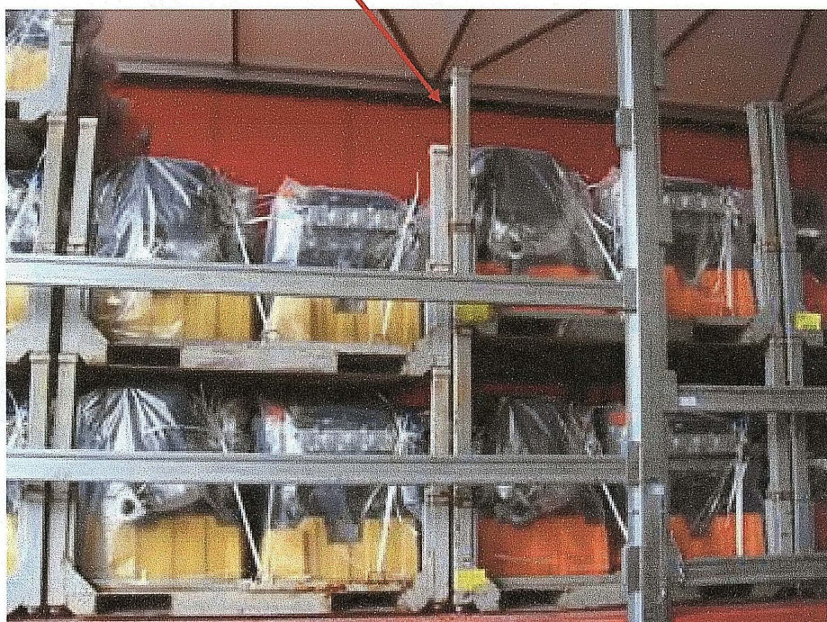
Figura 18 – Rack Metálico Cortado ao lado do Rack Sem Corte
