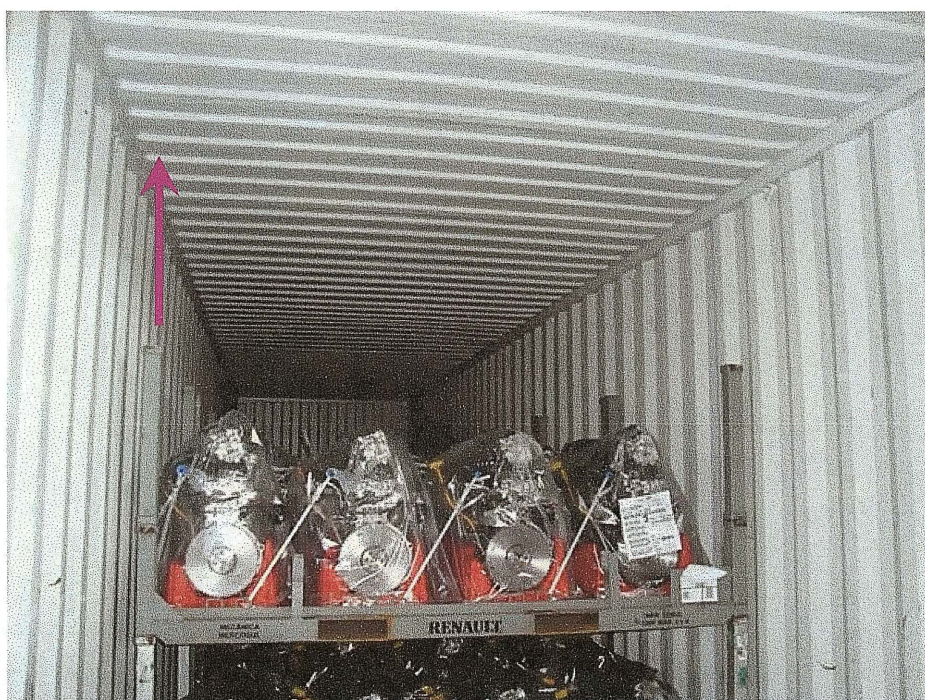
Figura 8 – Espaço não aproveitado sobre os racks dentro do container
