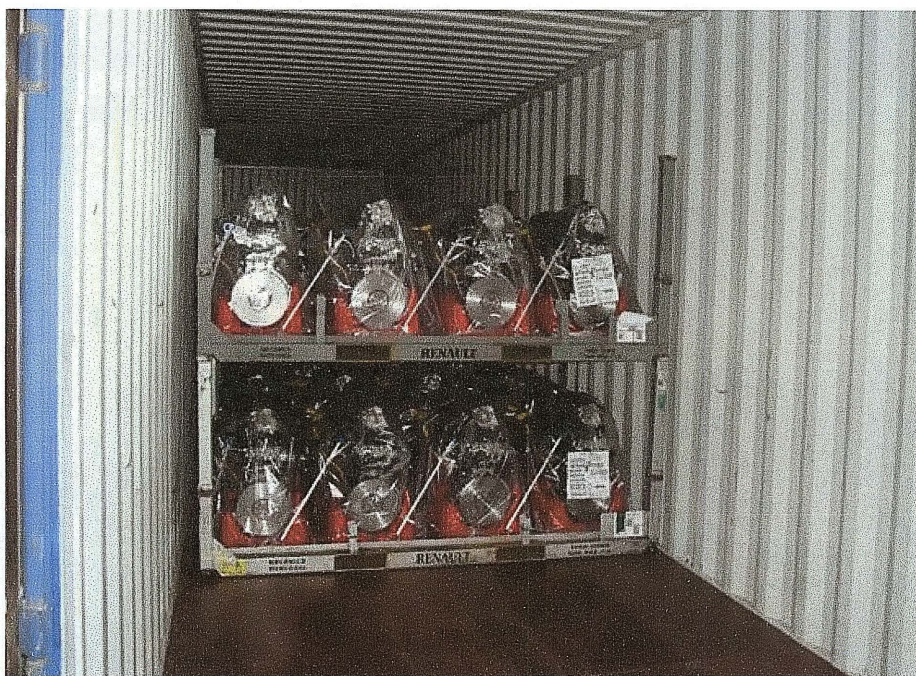
Figura 7 – Rack de Motor – Empilhamento máximo dentro do container - 2 racks
