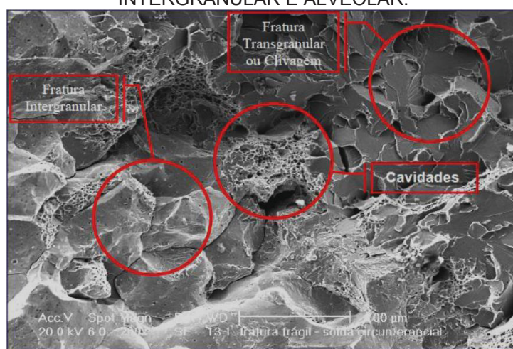
FIGURA 31 - MICROMECHANISMOS DE FRATURA COMBINADA: COM REGIÕES DE CLIVAGEM, INTERGRANULAR E ALVEOLAR.
