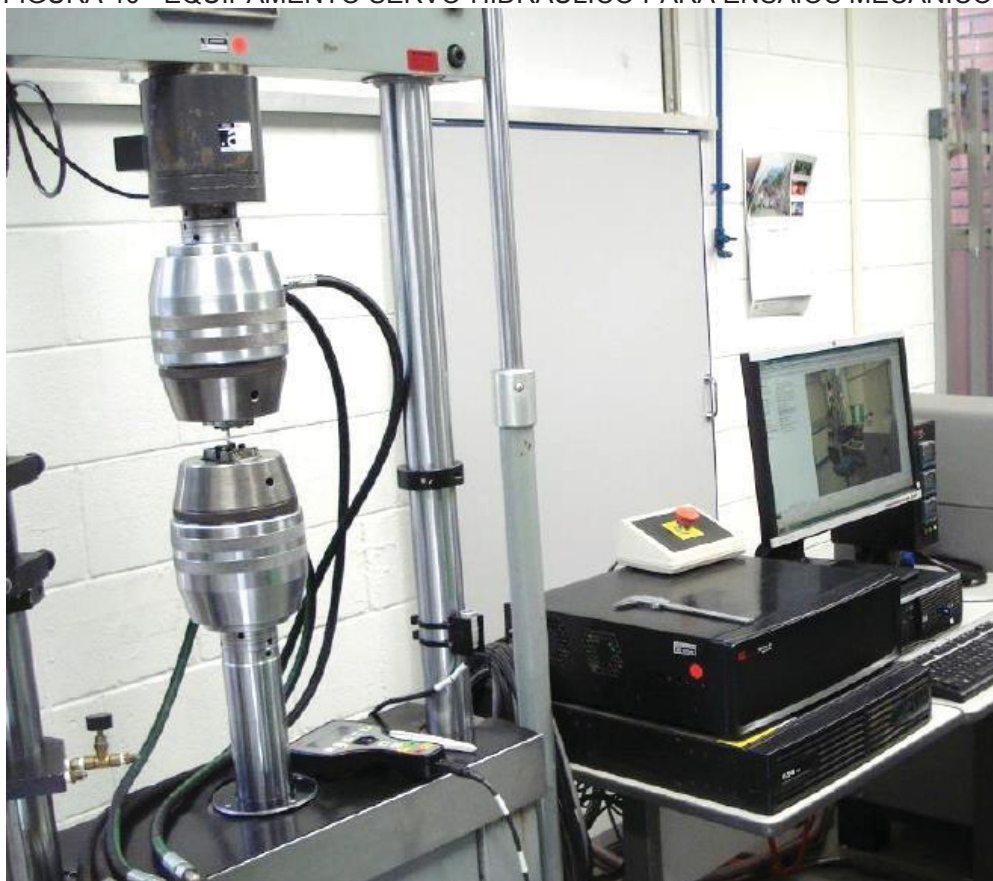
FIGURA 40 - EQUIPAMENTO SERVO-HIDRÁULICO PARA ENSAIOS MECÂNICOS
