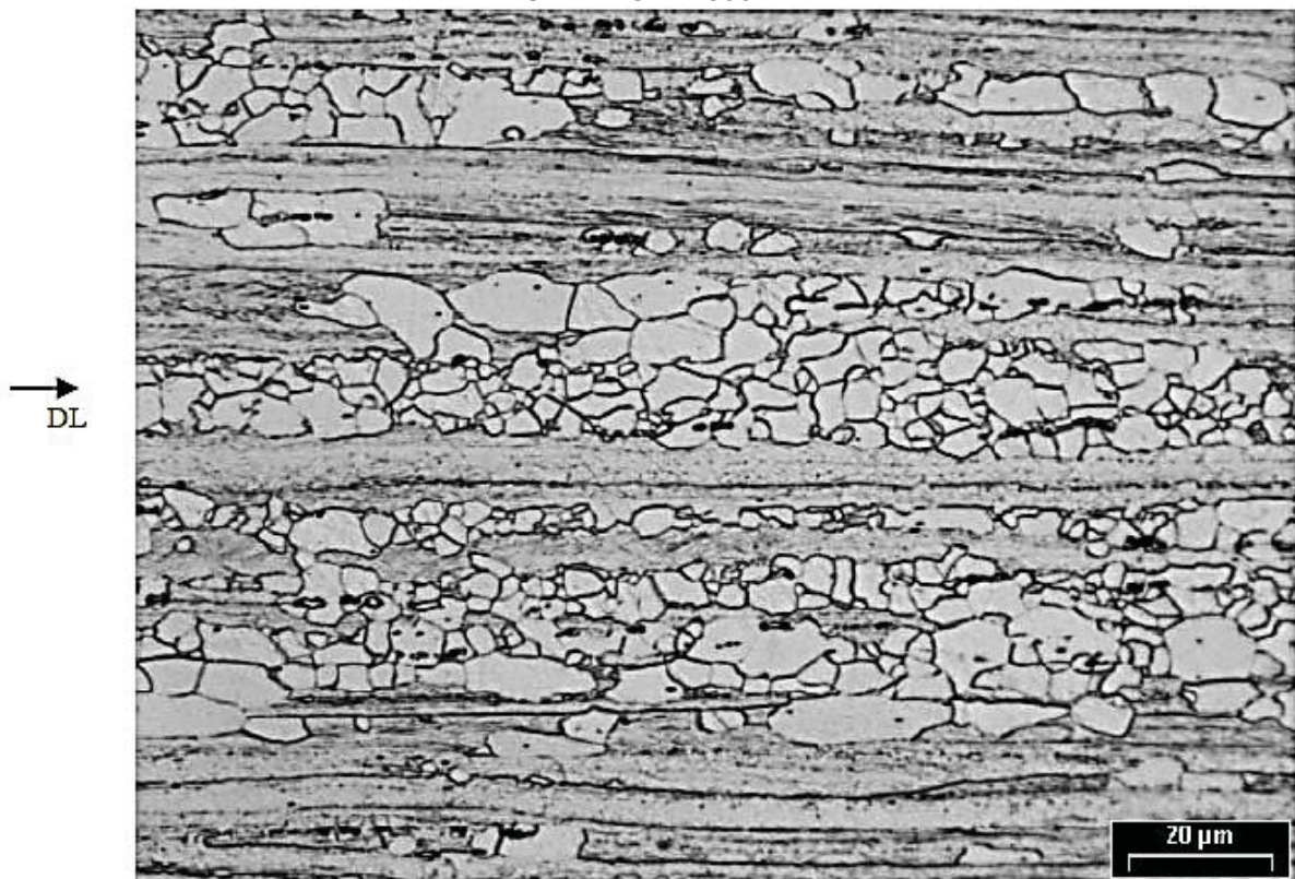
FIGURA 37 - HETEROGENEIDADE NA DISTRIBUIÇÃO DAS REGIÕES RECRISTALIZADAS, COM AUMENTO DE 500X.
