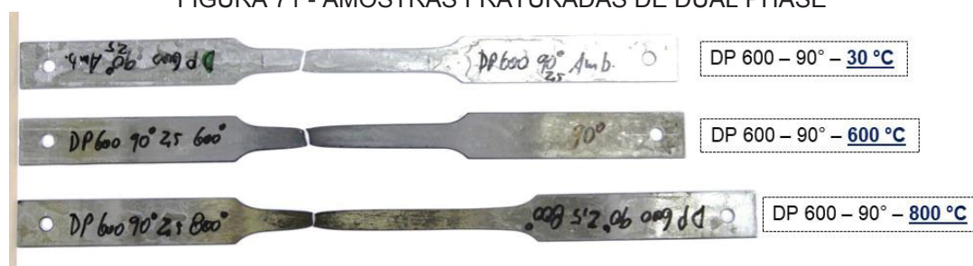
FIGURA 71 - AMOSTRAS FRATURADAS DE DUAL PHASE
