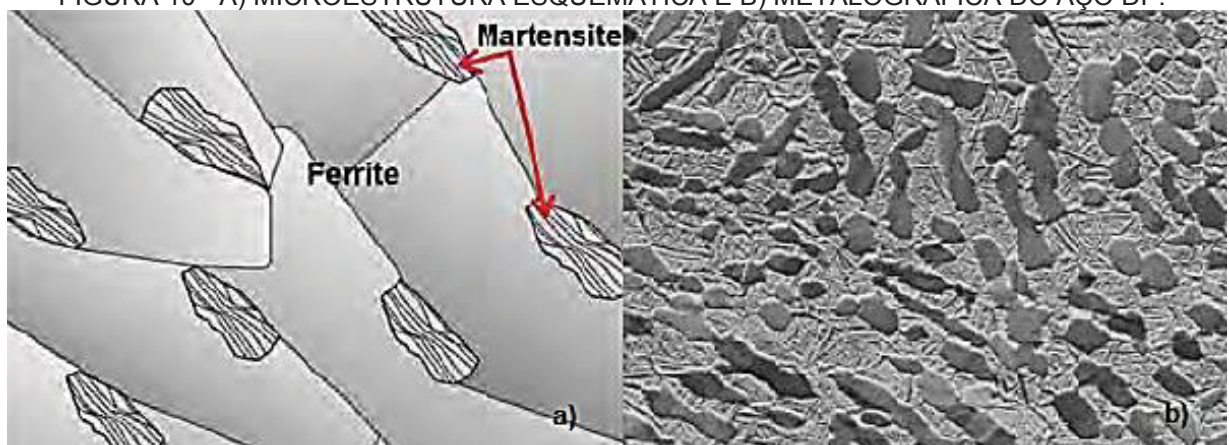
FIGURA 10 - A) MICROESTRUTURA ESQUEMÁTICA E B) METALOGRAFICA DO AÇO DP.
